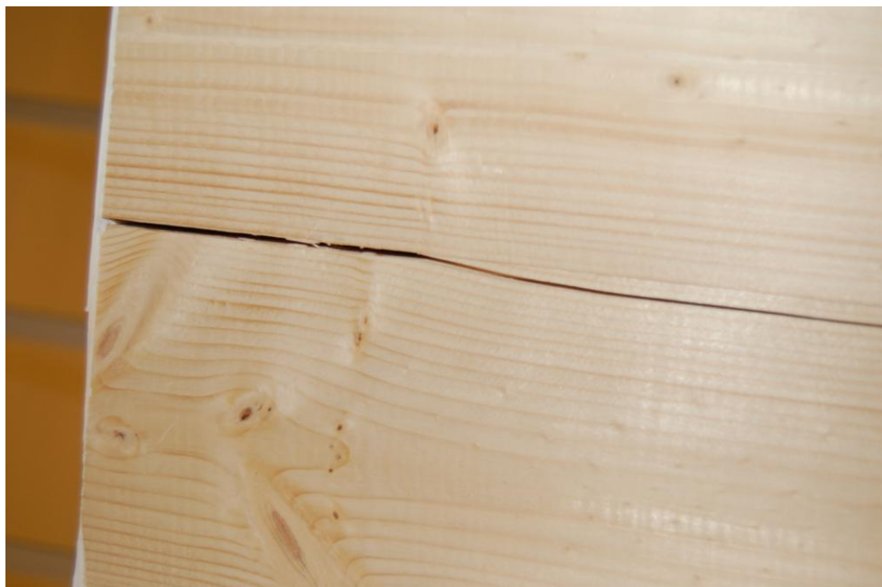
Figur 5. Hvis lim søles på kant under produksjon, sprekker det lett innad i bordene.
