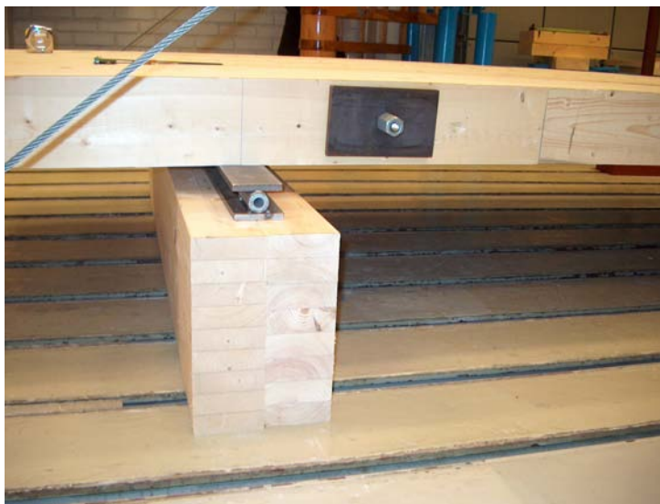
Bilde 3. Fritt opplagt massivtreelement.
