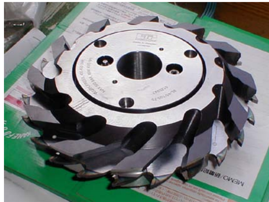
Figur 4. Kvarnstrands Verktøys nye notfres. Prinsippet med et mangetannet sagblad for utfresing av nota er fortsatt beholdt.
