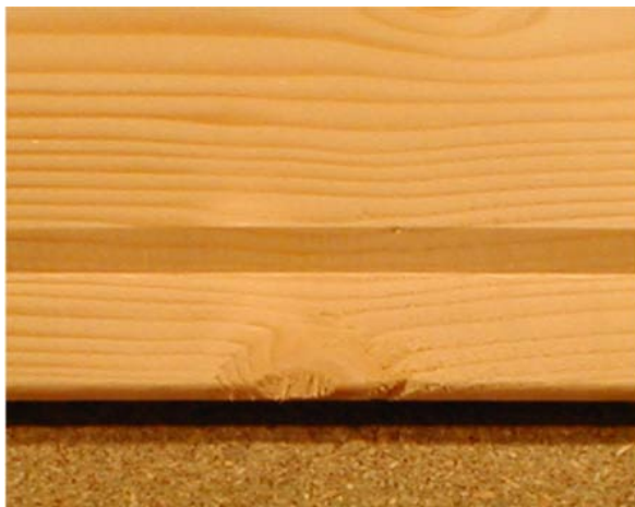
Figur 26. Små utslag i og omkring kvoist på fjær. Utslagene vil være skjult etter panelmontasjen.
