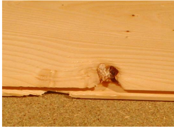
Figur 22. Et utslag innen fiberforstyrrelser i underleppe, og utslag av og omkring kvoist i overleppe. Kvoisten har antakelig vært en løskvoist. Utslaget videre mot overleppens skrå kant antas er pga. fiberretningen i fiberforstyrrelsene å være forårsaket av notverktøyet.
