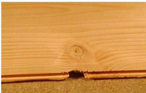
Figur 21. Et lite utslag innen fiberforstyrrelser i overleppe, og utslag i og omkring kvist i underleppe. Det siste kan være forårsaket av overkutter. Utslag i notens underleppe er ikke tatt med i statistikken.
