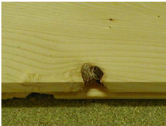
Figur 25. Utslått løskvist i overleppens skrå kant.
