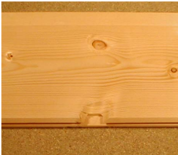
Figur 20. Utslag i overleppe innen fiberforstyrrelser på notsiden. Dybden er lik tykkelsen på notens overleppe. Det antas at utslaget er forårsaket av underkutter og således ikke av notverktøyet.
