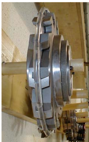
Figur 3. Notfres fra Kvarnstrands Verktøy som eksisterte ved prosjektets start. Merk sagbladet som freser ut nota.
