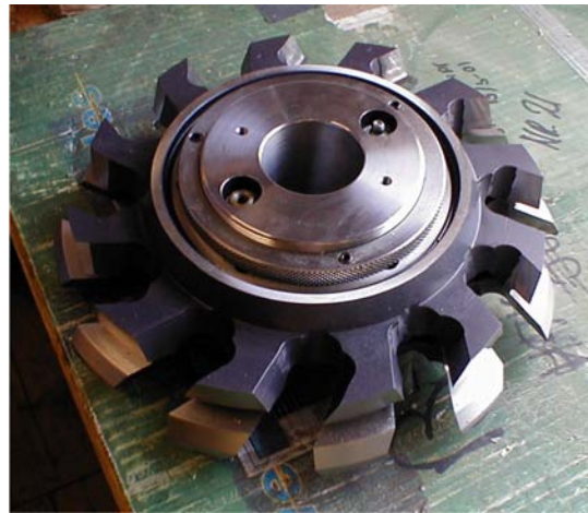
Figur 5. Kvarnstrands Verktøys nye forprofilerende fjærfres.
