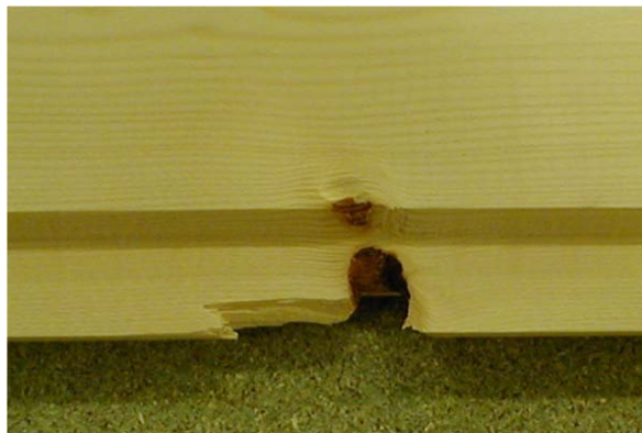
Figur 31. Utslaget har tatt kvist (løskvist?) i fals pluss deler av fjær. En av bedriftene har konstatert at skråstilte skjær på staff-fresen fremmer store utslag i fjær. Rette skjær på staff synes å gi bedre resultat. Figuren viser dessuten et lite kvistutslag i 30° skrå kant.
