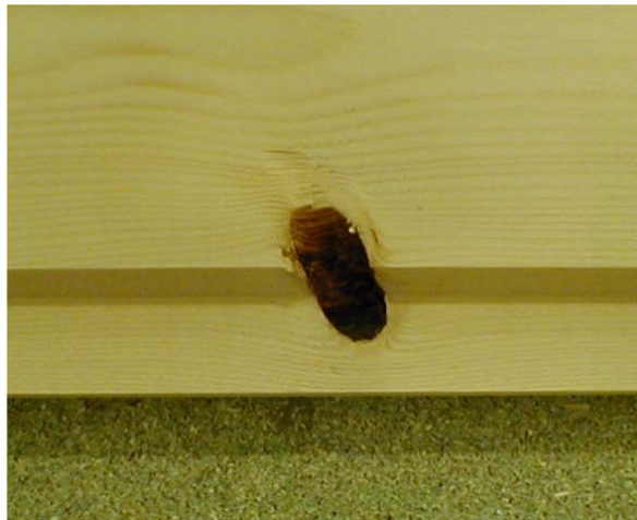
Figur 30. Kvisthull i 30° skrå kant og fals på fjærsiden.
