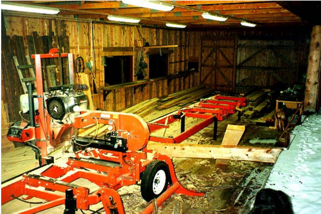
Figur 7-4 Bilde av mobil båndsag her montert som stasjonær sag i hus.
