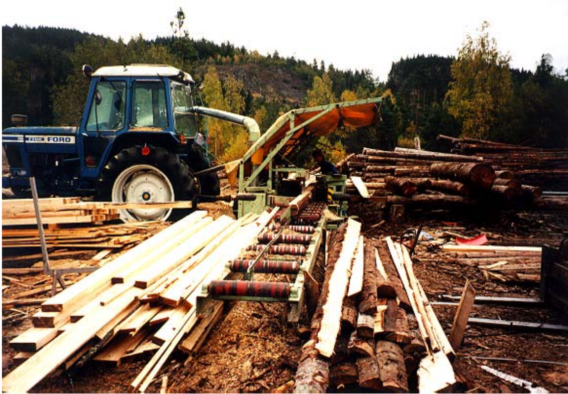
Figur 7.3 Bilde av mobil sirkelsag.
