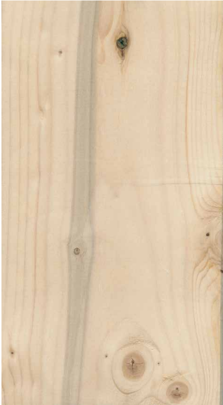
Figur 6. Blåved, ingen nedklassing av denne planken.
