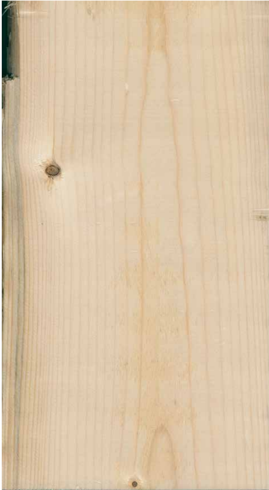
Figur 4. Fargen til venstre tolkes som blåved / barkbrunt. Godtas i alle klasser. Skaden til høyre godtas i alle klasser. Vankanten (vanskelig å se) er mindre enn \frac{1}{3} av tykkelsen og godtas også i alle klasser.
