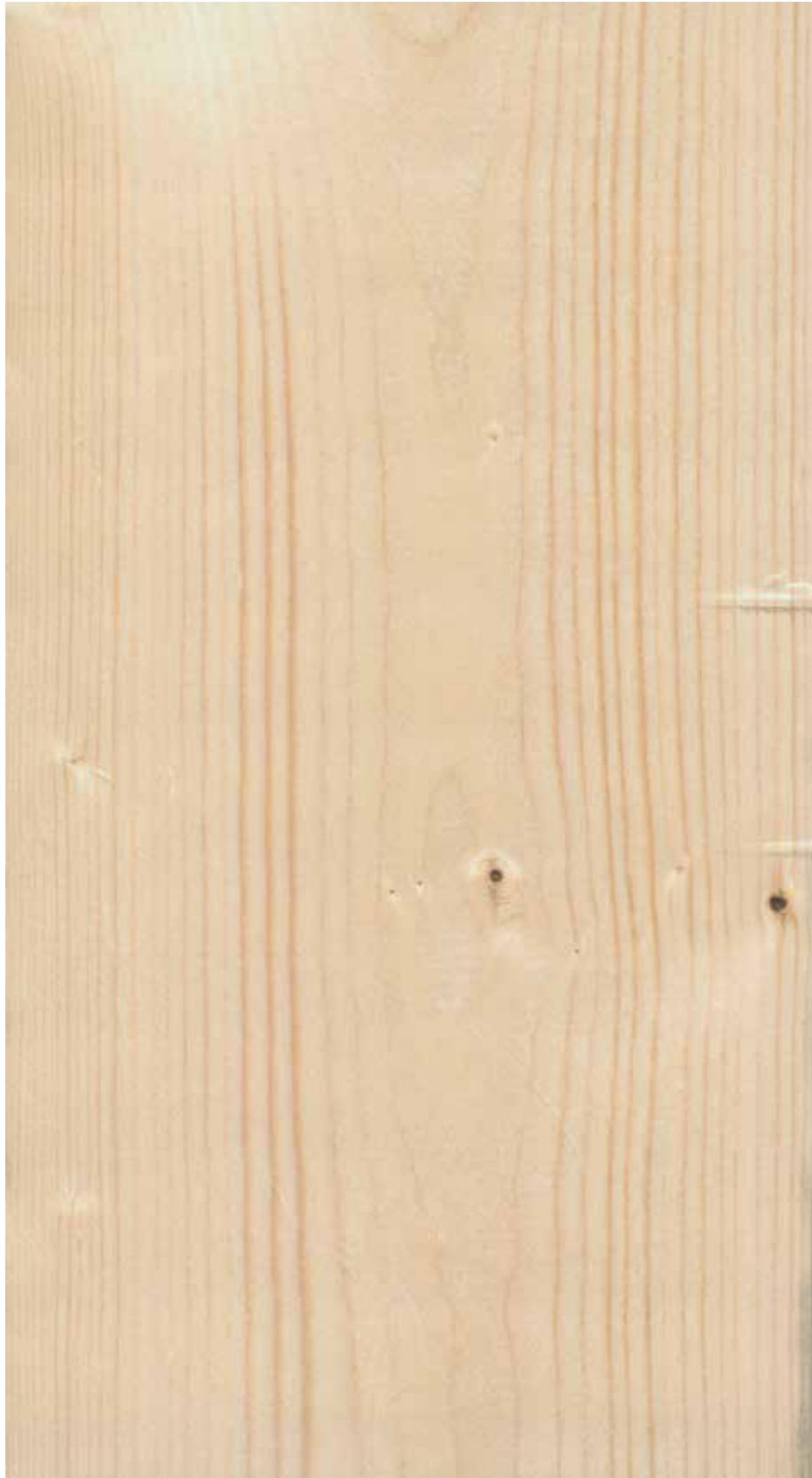
Figur 65. Mindre skade, men for stor til at planken kan sorteres til klasse C30. Planken må nedklasses til C24.
