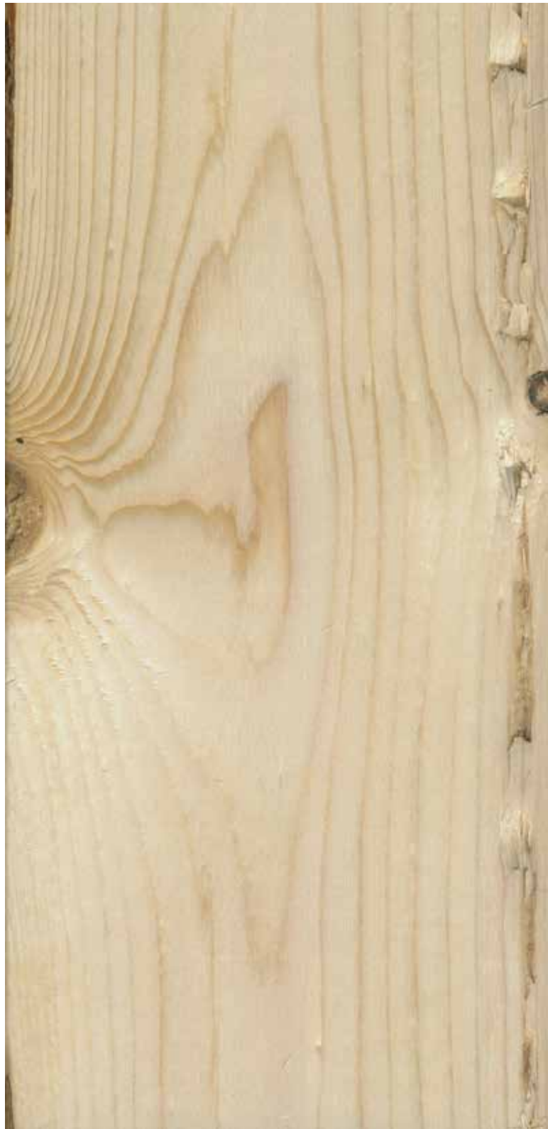
Figur 80. Skader etter hogstmaskin og barkemaskin vurderes litt strengere enn høvelutslag. Planken må nedklasses til C24.
