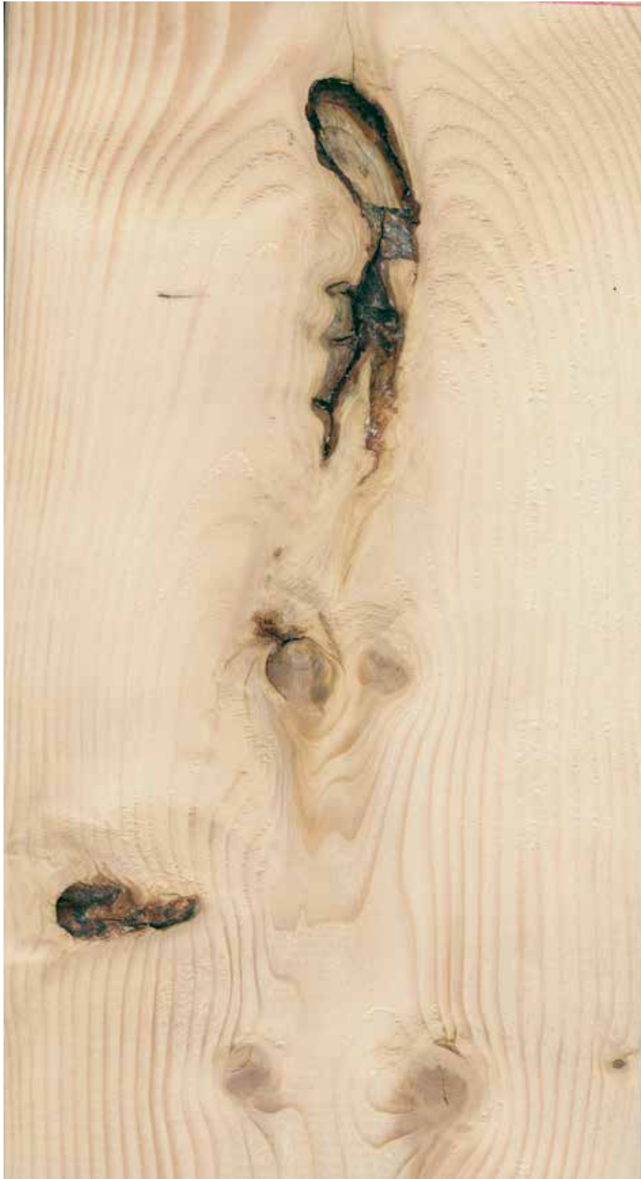
Figur 57. Føyren nede til venstre er mer enn \frac{1}{3} av plankens bredde. Planken vrakes.
