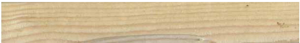
Figur 77. Skade i form av avriv på kant aksepteres dersom vankantkravet er oppfylt. Ingen nedklassing av denne planken.
