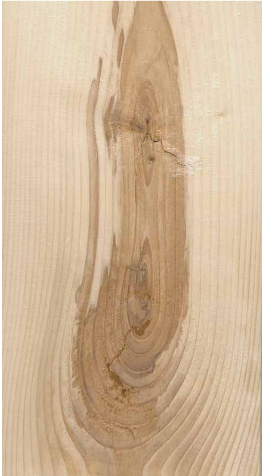
Figur 20. Råte, planken vrakes. Her er det også åpent vre som alene ville medføre at planken skulle vrakes.
