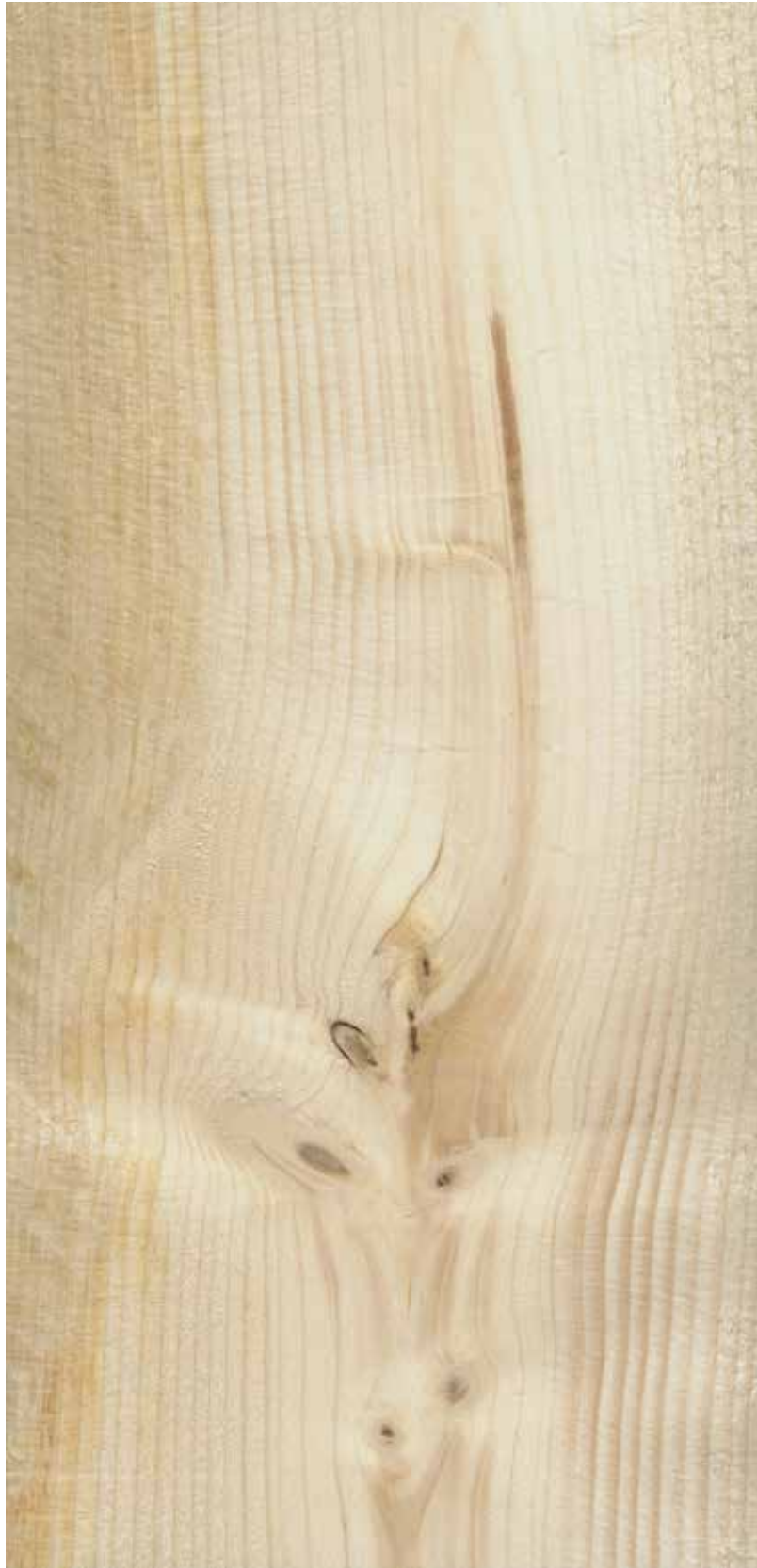
Figur 51. Mindre toppbrudd, men for stort til at planken kan sorteres til klasse C30. Planken må nedklasses til C24.
