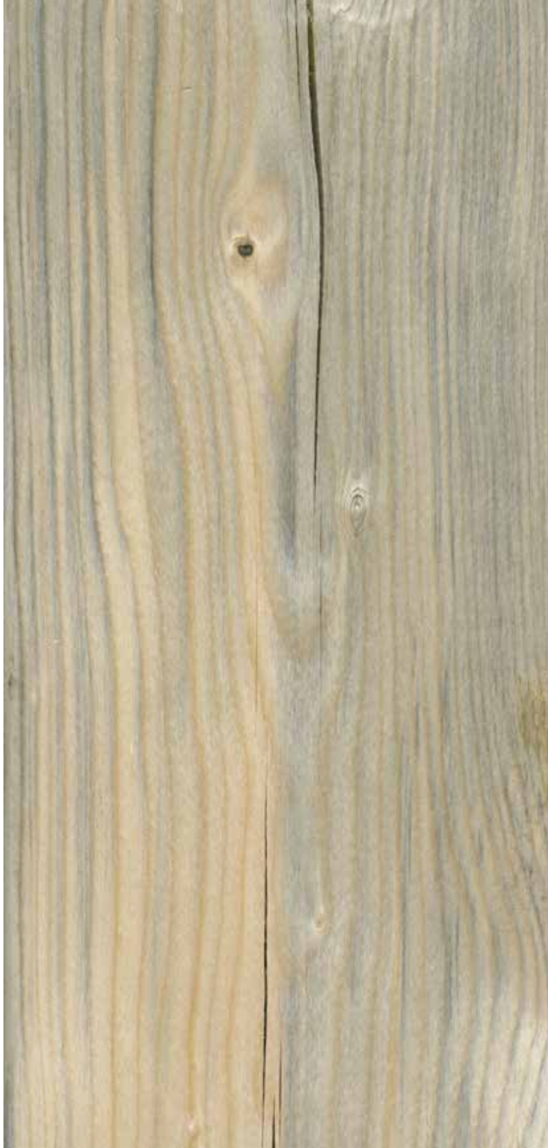
Figur 7. Blåved, ingen nedklassing av denne planken.
