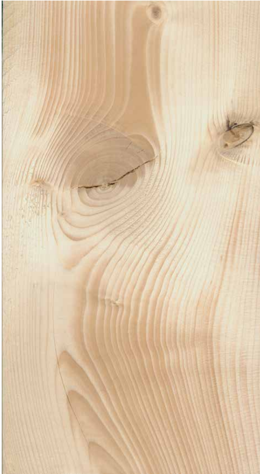
Figur 47. Vre med sprekk i seg (åpent vre) vrakes alltid. Hadde det ikke vært sprekk i dette vreet ville det være for stort til at planken kan sorteres til klasse C30. Planken ville da nedklasses til C24.
