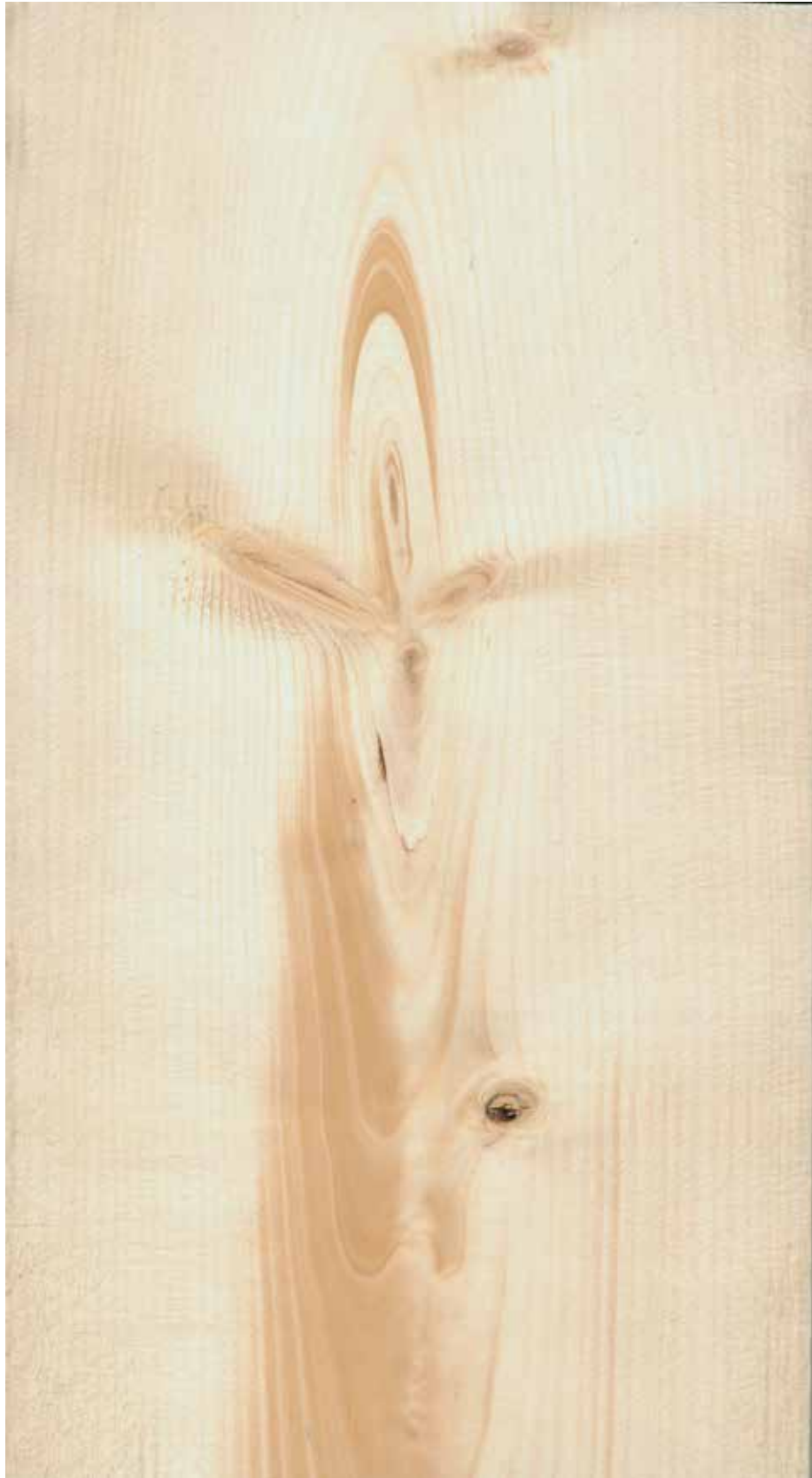
Figur 37. Tennar rundt et lite vre. Ingen nedklassing av denne planken.
