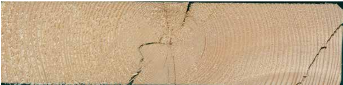
Figur 82. Sprekk over kant som man ser til høyre i bildet er ikke akseptert, planken vrakes.
