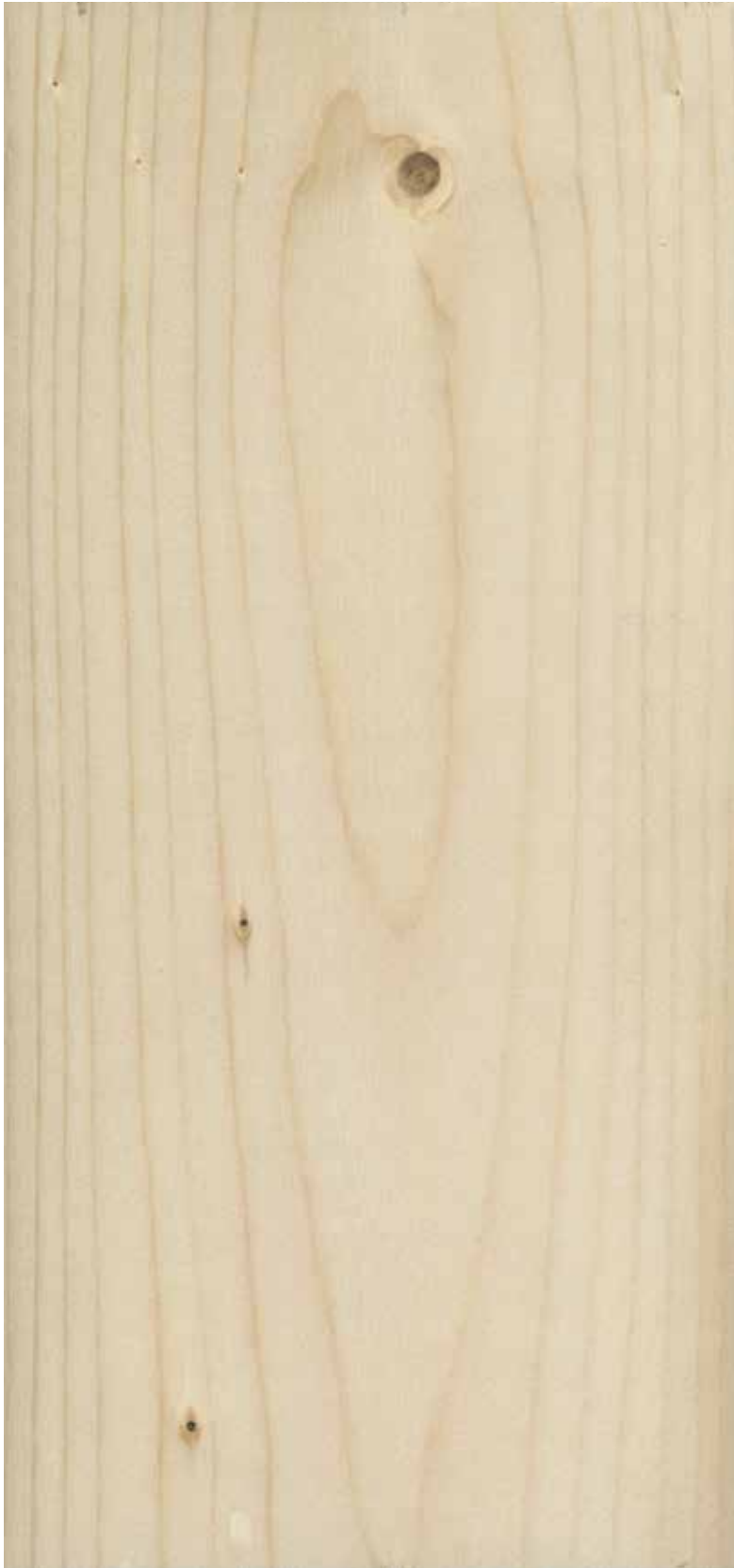
Figur 28. Litt råte ut i veden fra en kvist kan aksepteres, såkalt «øyenskygge». På bildet ses «øyenskyggen» på den midterste kvisten. Ingen nedklassing av denne planken.
