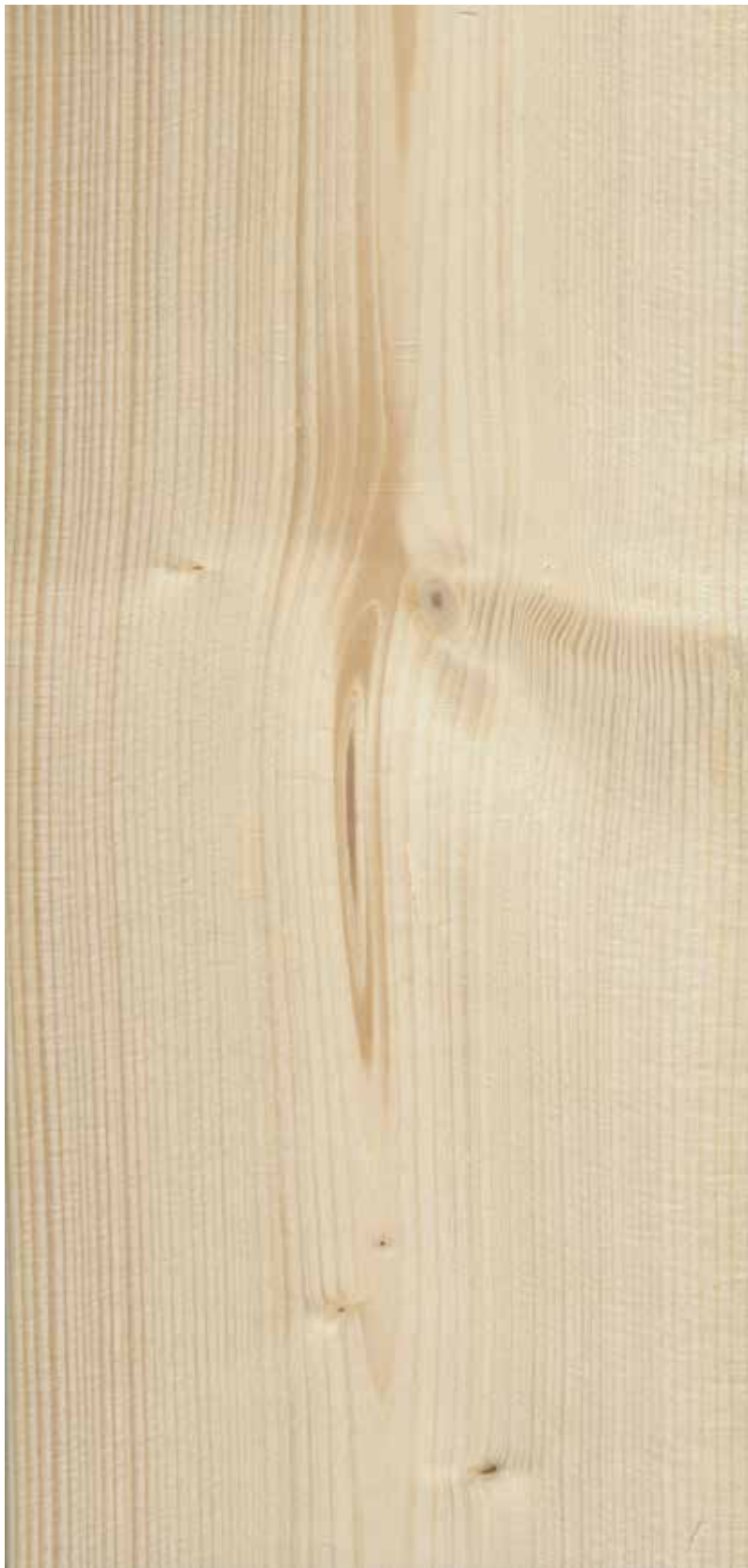
Figur 46. Lite vre, ingen nedklassing av denne planken.
