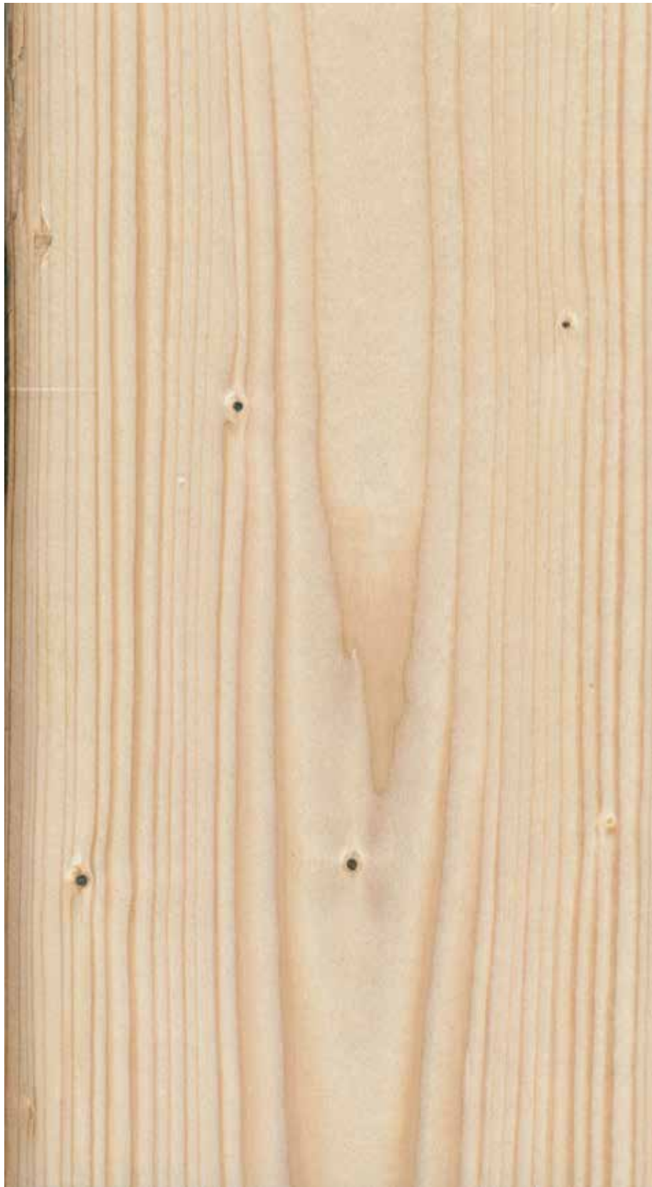
Figur 60. Meget liten skade. Ingen nedklassing av denne.
