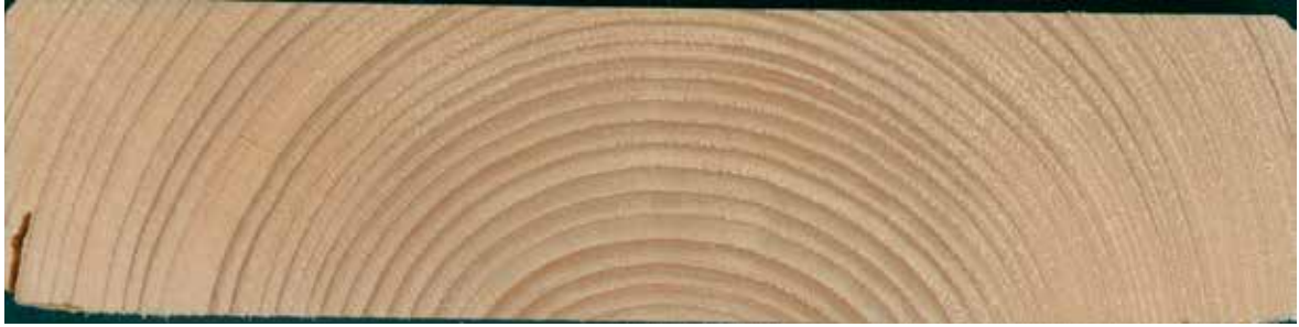
Figur 41. Svak tennar sett i plankens tverrsnitt. Ingen nedklassing av denne dersom planken er rett.
