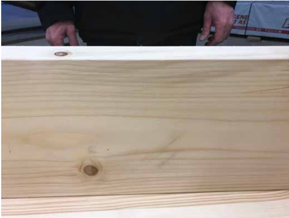
Figur 9. Fargen øverst på planken tolkes som brent. Fargen er ikke bare i kanten av planken, men også innover i veden. Planken sorteres til C18 på grunn av brent med mindre brent-området er gjennomgående, da må planken vrakes.
