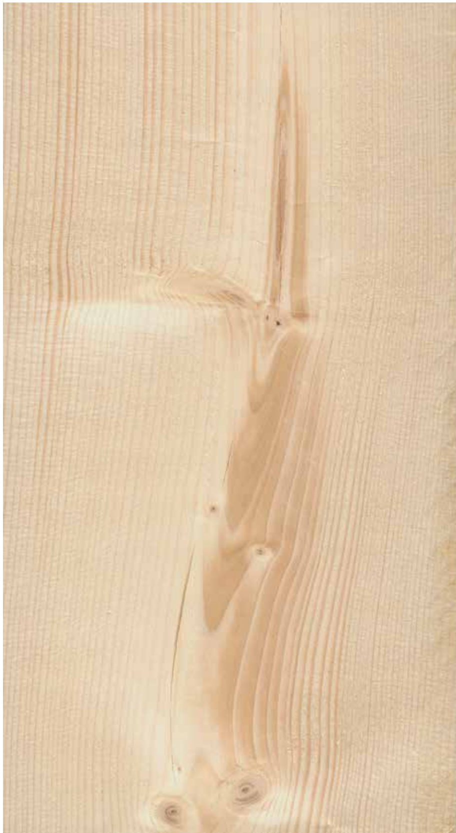
Figur 45. Lite vre, ingen nedklassing av denne planken.
