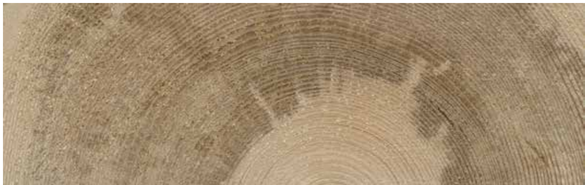
Figur 2. I dette tverrsnittet ser man brent som beveger seg fra utsiden av tømmeret og innover. Råte kommer som regel fra margen og beveger seg utover.
