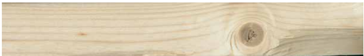
Figur 78. Her er vankantkravet ikke oppfylt, planken vrakes.
