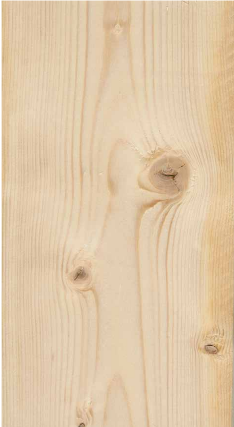
Figur 29. Litt misfarging og skurflate til høyre på planken. Ingen nedklassing av denne planken.
