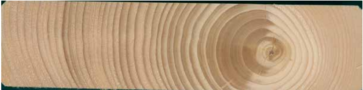
Figur 43. Kraftig tennar sett i plankens tverrsnitt. Planken vrakes.
