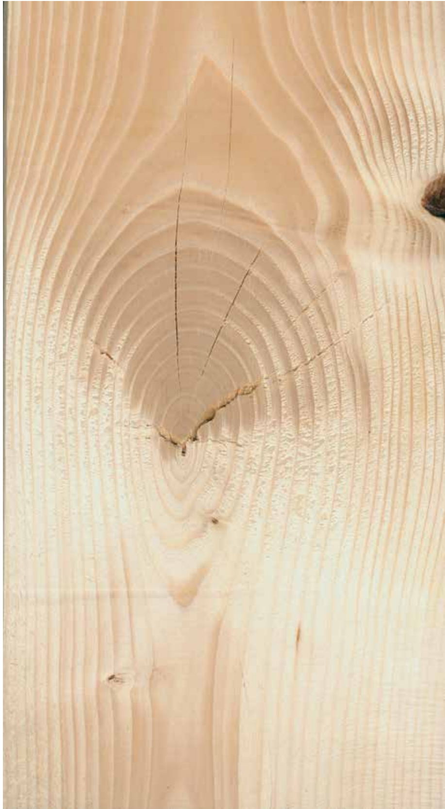
Figur 49. Åpent vre, planken vrakes. Også størrelsen av vreet betyr at planken må vrakes.
