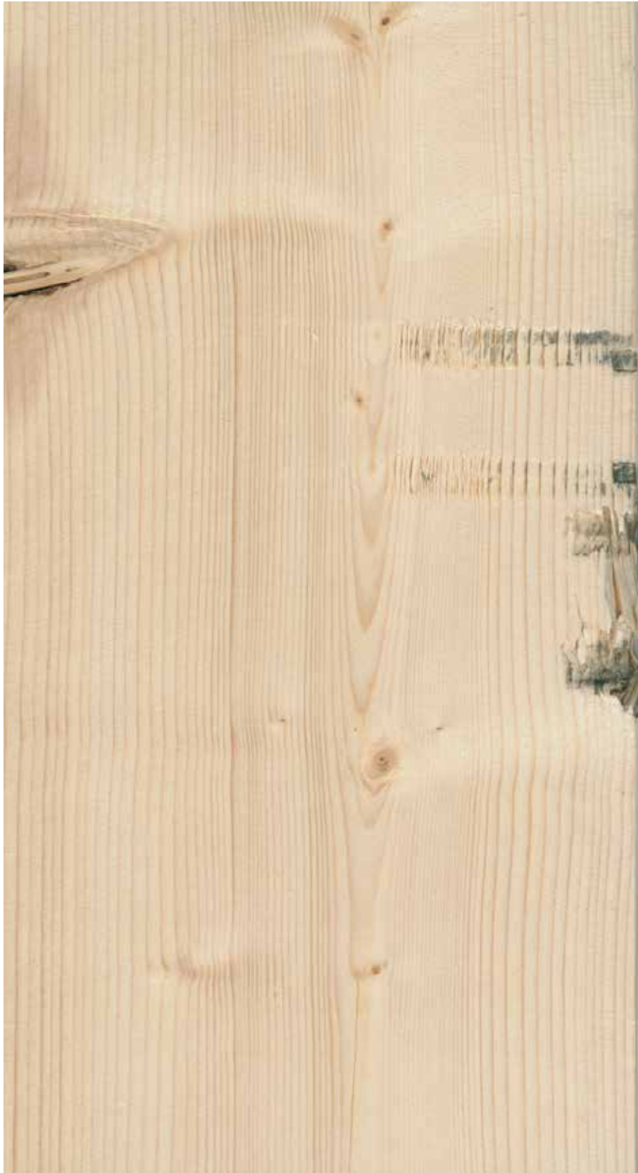
Figur 68. Skade etter elevatorkjede inn på tørrsorteringen. Planken vrakes.
