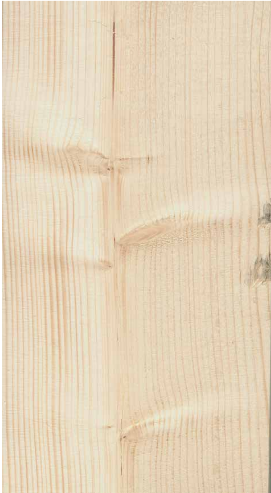
Figur 62. Mindre skade, men for stor til at planken kan sorteres til klasse C30. Planken må nedklasses til C24.
