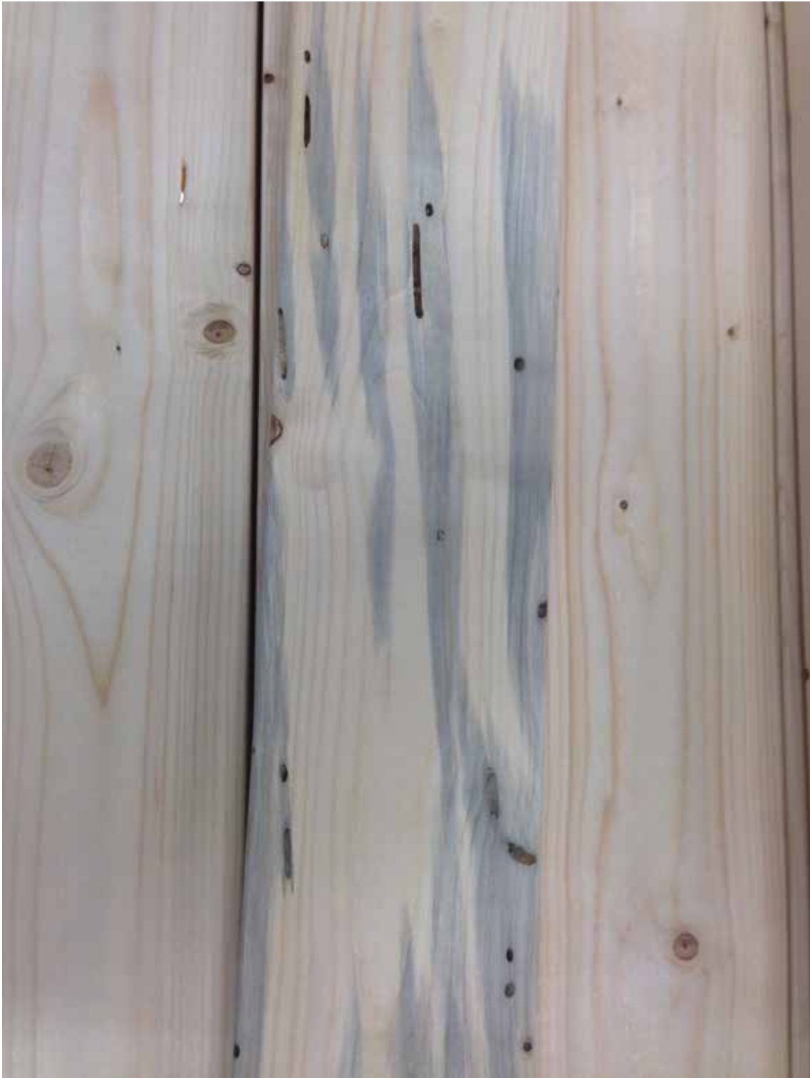
Figur 84. Ofte ser man insektskader sammen med blåved. Insektskader er ikke tillatt uansett mengde og størrelse. Planken vrakes.
