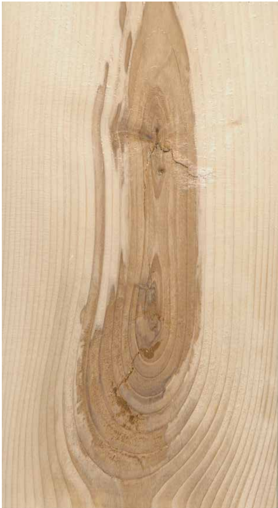
Figur 50. Råte i et vre, planken vrakes.
