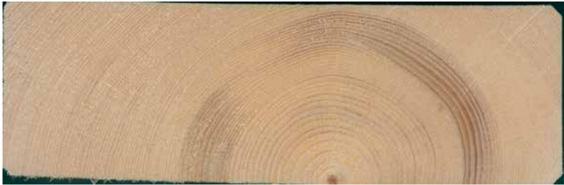
Figur 42. Forholdvis svak tennar i et begrenset område. Ingen nedklassing av denne dersom planken er rett.
