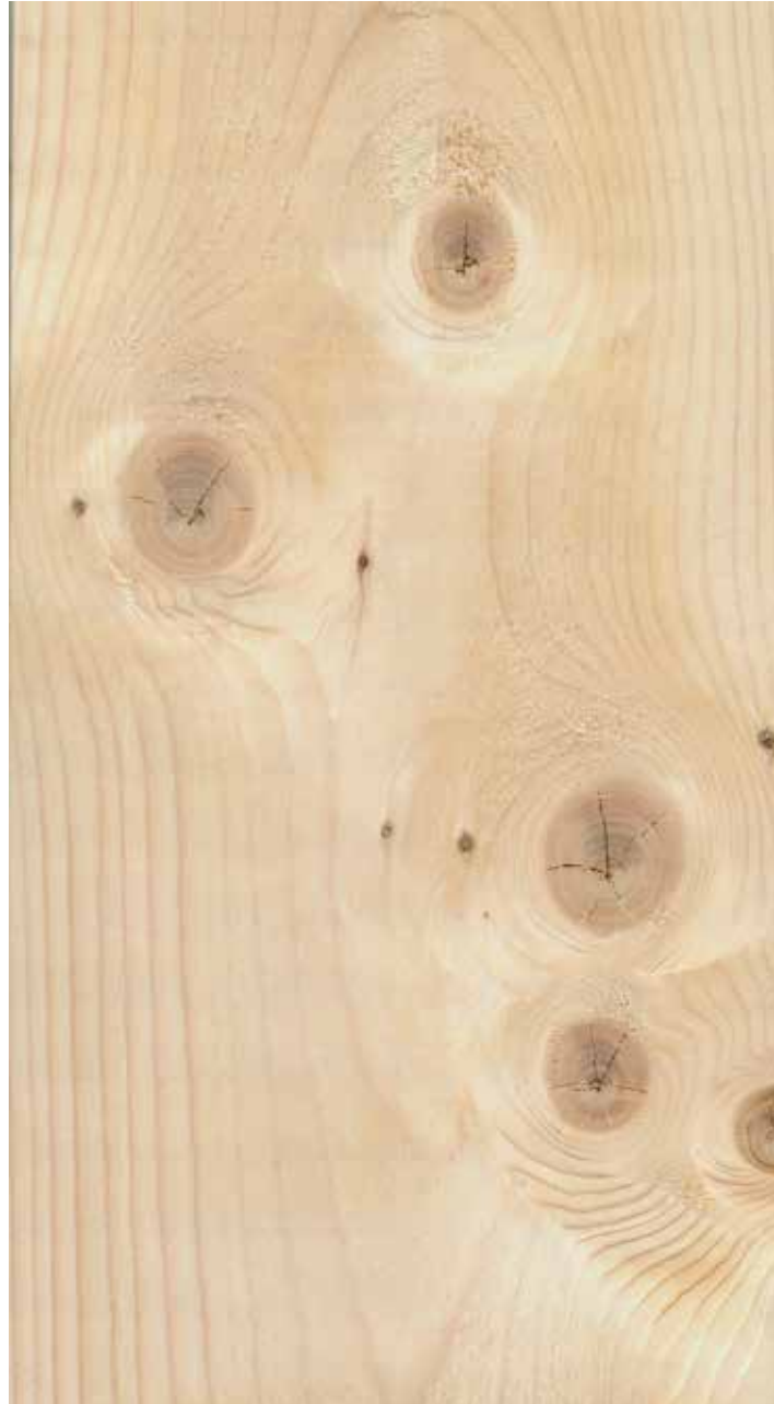
Figur 1. Visuell sortering skal ikke utføres på kvist når virket først er blitt sortert av en styrkesorteringsmaskin.
