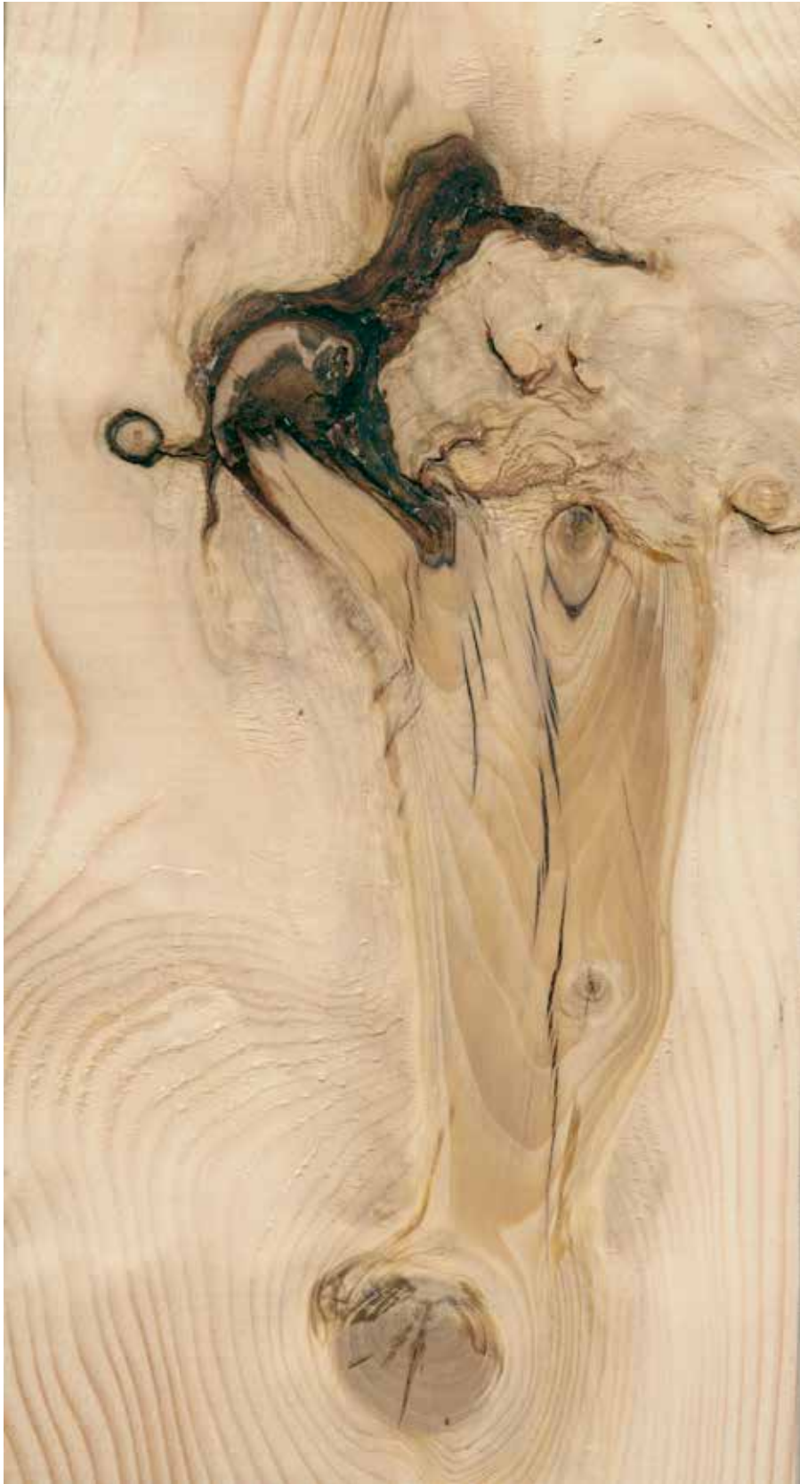
Figur 59. Føyren er mer enn \frac{1}{3} av plankens bredde. Planken vrakes.
