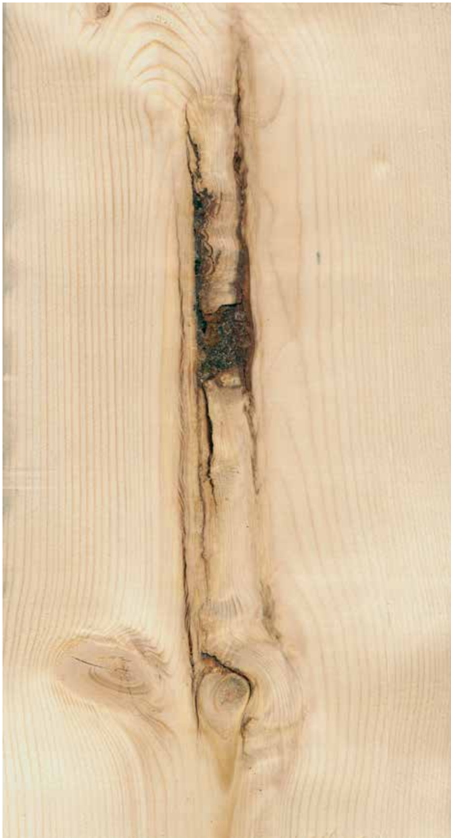
Figur 55. Ingen nedklassing av denne planken.
