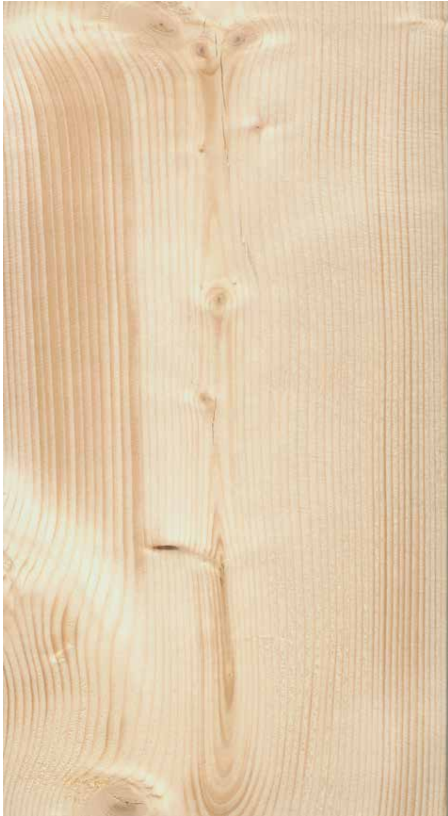
Figur 35. Forholdsviis svak tennar på venstre side. Ingen nedklassing av denne planken.
