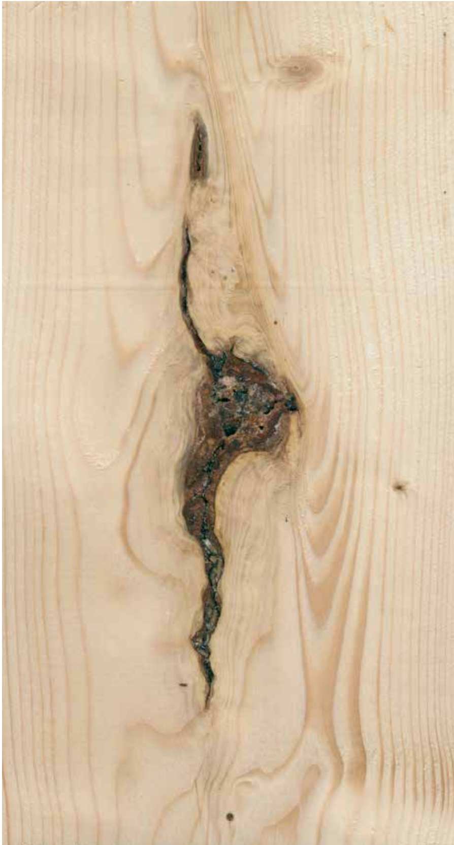
Figur 58. Føynen er mer enn \frac{1}{3} av plankens bredde. Planken vrakes.
