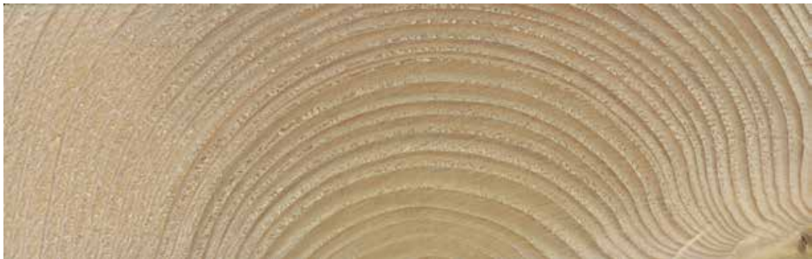
Figur 44. Kraftig tennar sett i plankens tverrsnitt. Planken vrakes.
