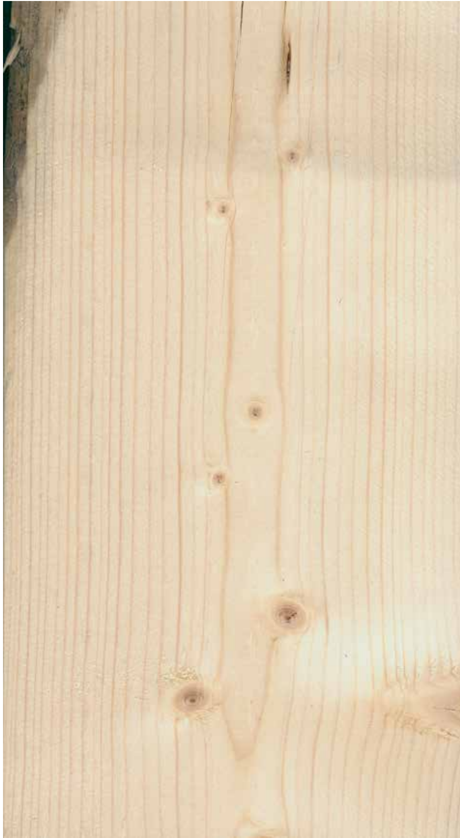
Figur 31. Fargen oppe til venstre skyldes smuss og farge fra møkkete vann. Ingen nedklassing av denne planken.
