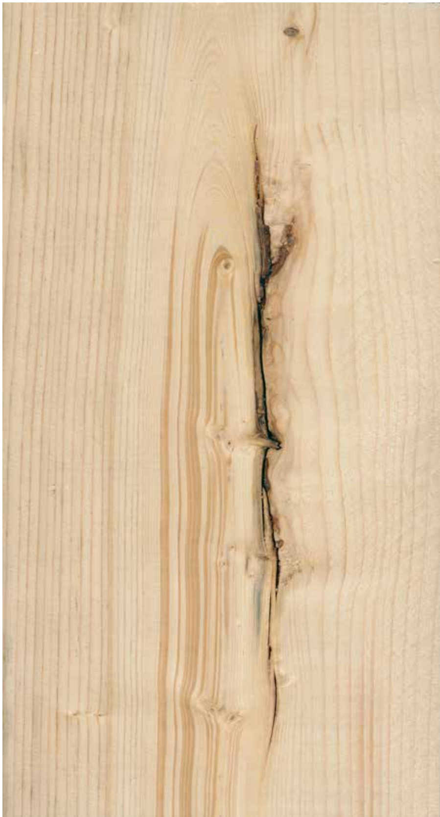
Figur 54. Ingen nedklassing av denne planken.
