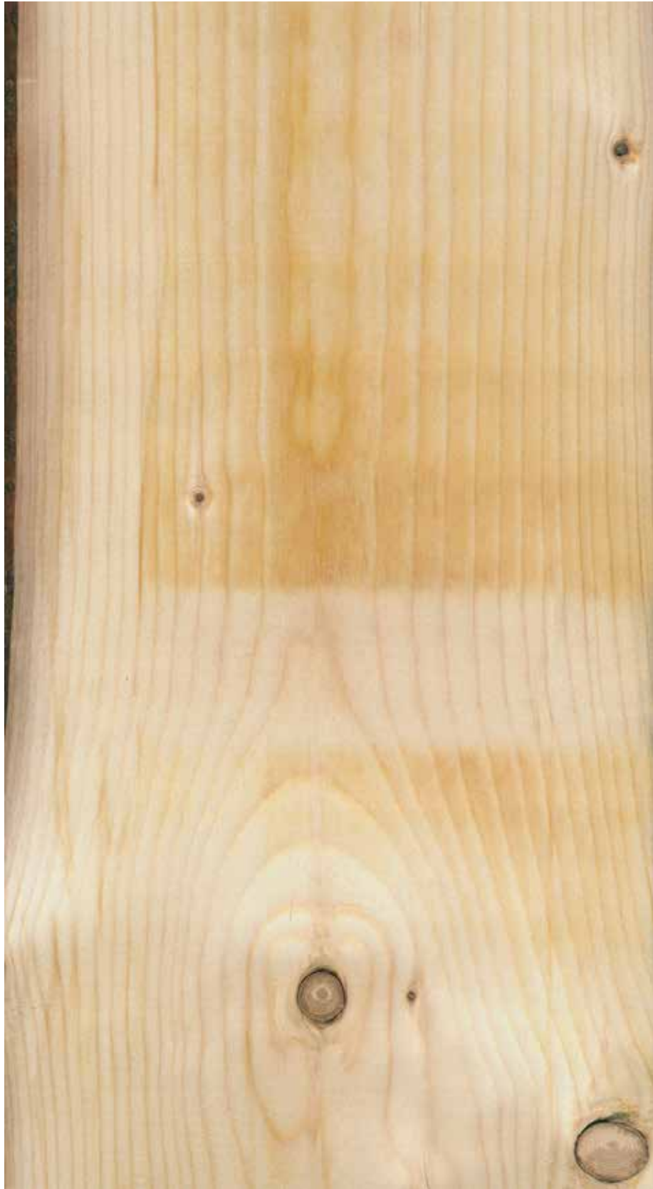
Figur 30. Barkbrunt oppe til venstre og misfarging etter vann fra tørkene (hvite spor etter strø er synlig). Ingen nedklassing av denne planken.
