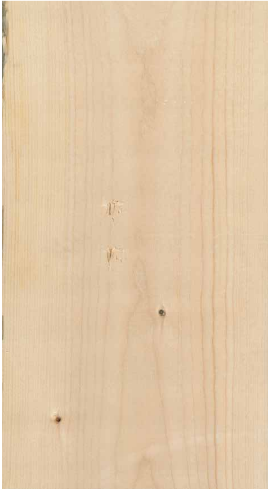
Figur 64. Mindre skade, men for stor til at planken kan sorteres til klasse C30. Planken må nedklasses til C24.
