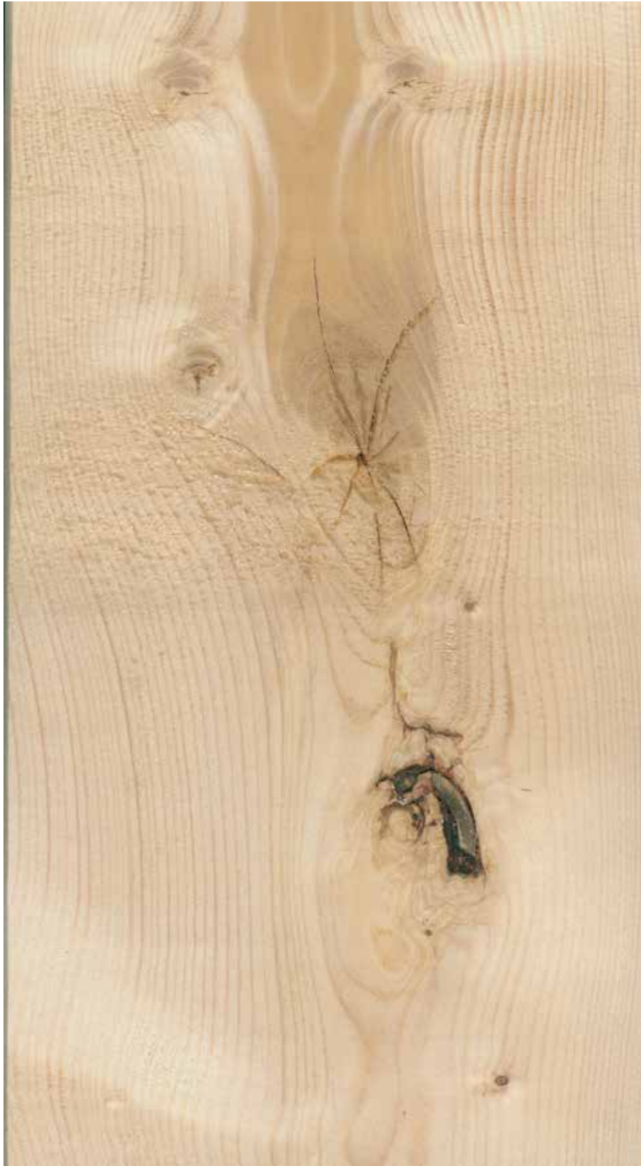
Figur 48. Åpent vre, planken vrakes. Hadde det ikke vært sprekk i dette vreet, ville det være for stort til at planken kan sorteres til klasse C30. Planken ville da nedklasseres til C24.
