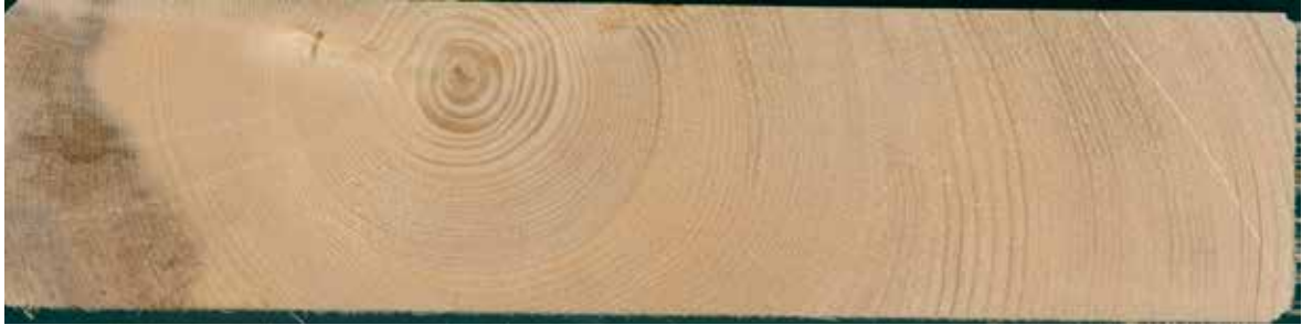
Figur 14. Gjennomgående brent er ikke akseptert. Planken vrakes.
