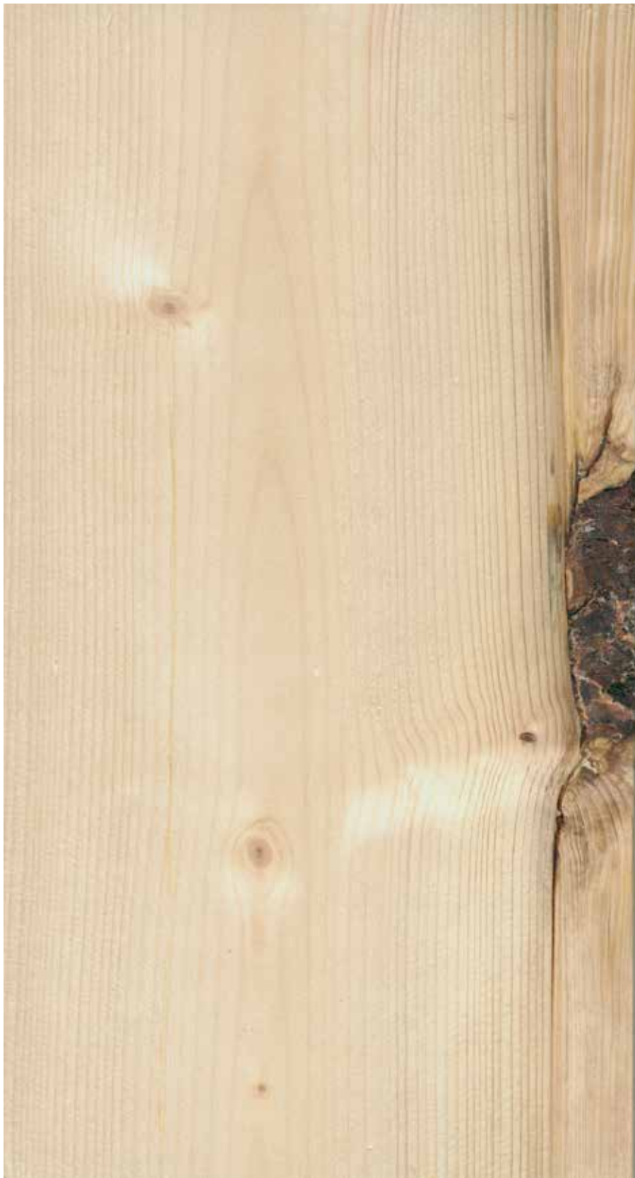
Figur 56. Føyren er ikke gjennomgående, ingen nedklassing av denne planken.
