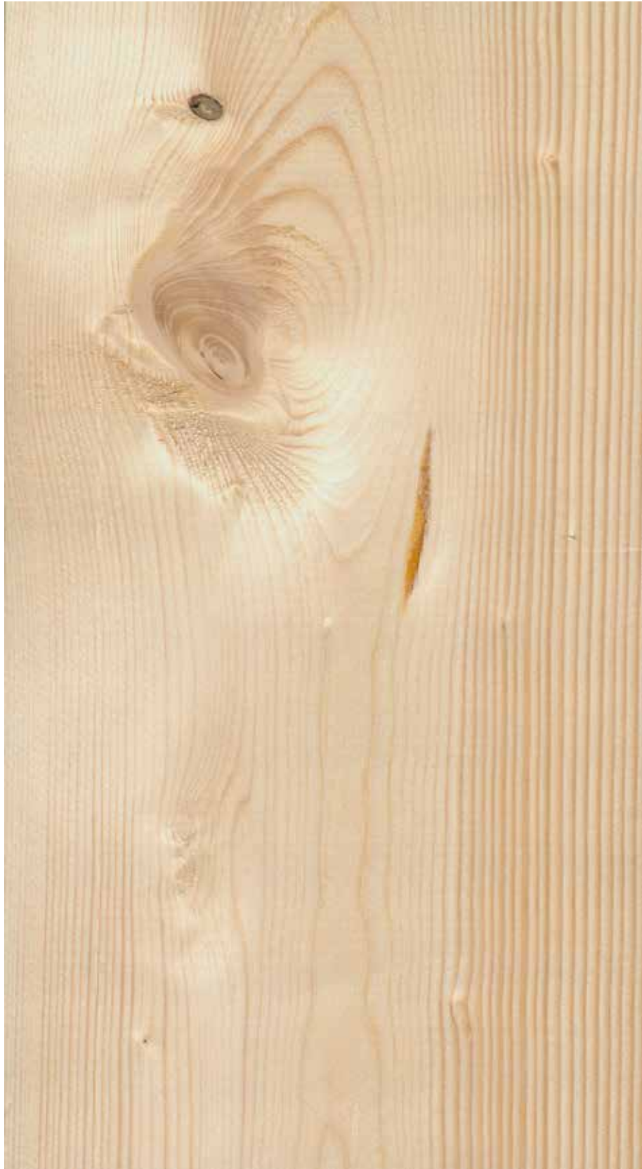
Figur 33. Litt tennar rundt en kvoist og veldig svak tennar til høyre. Ingen nedklassing av denne planken.
