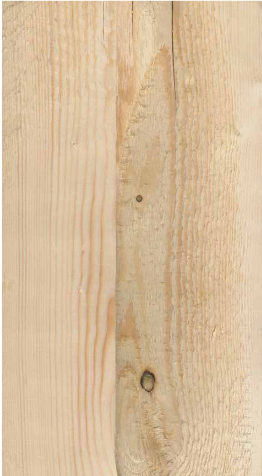
Figur 61. Skurflate, ingen nedklassing av denne. (Standarden for sortering av konstruksjonsvirke har ingen krav til høvlingskvalitet, men vær oppmerksom på at din bedrift kan ha satt egne krav).
