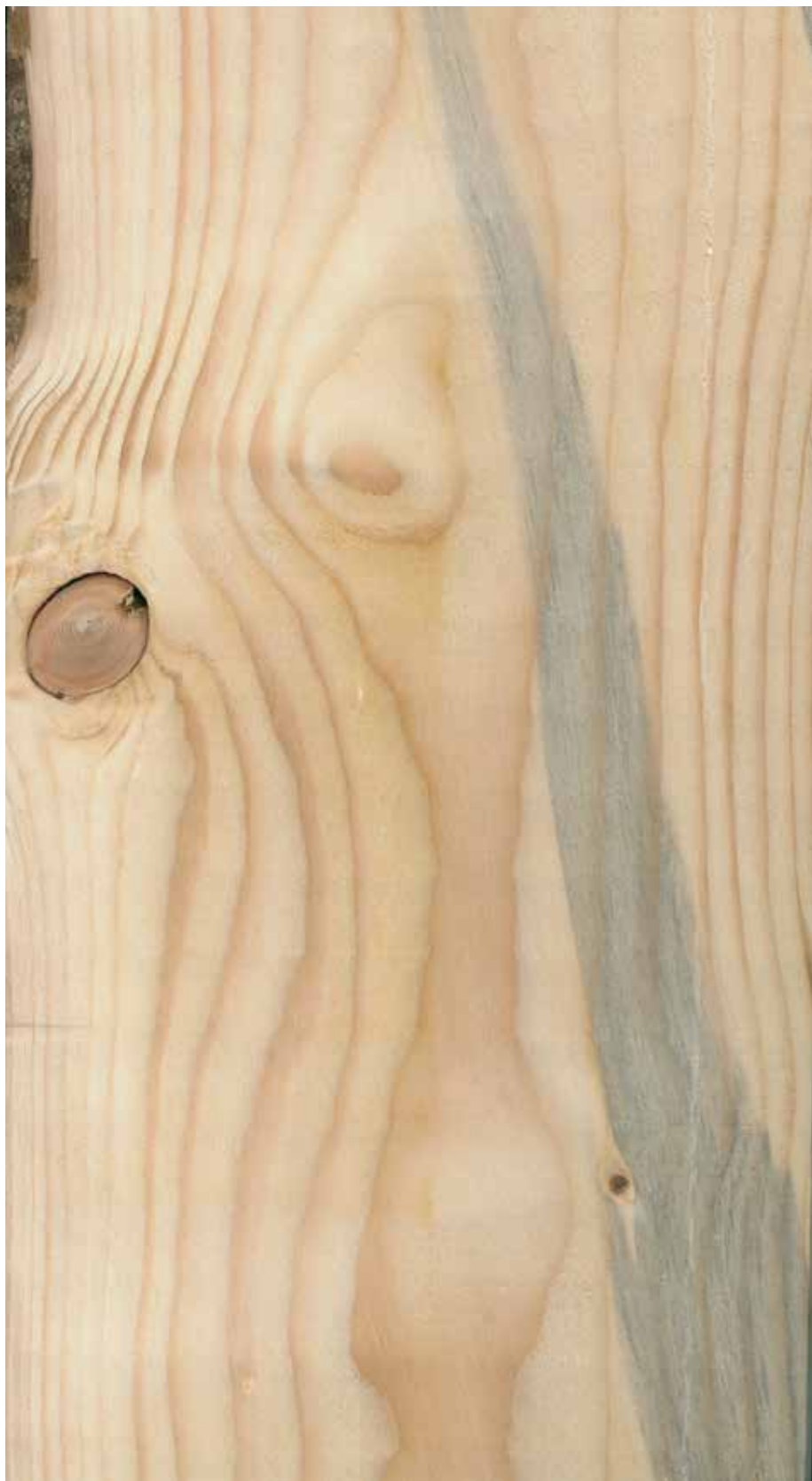
Figur 5. Blåved og barkbrunt, ingen nedklassing av denne planken.
