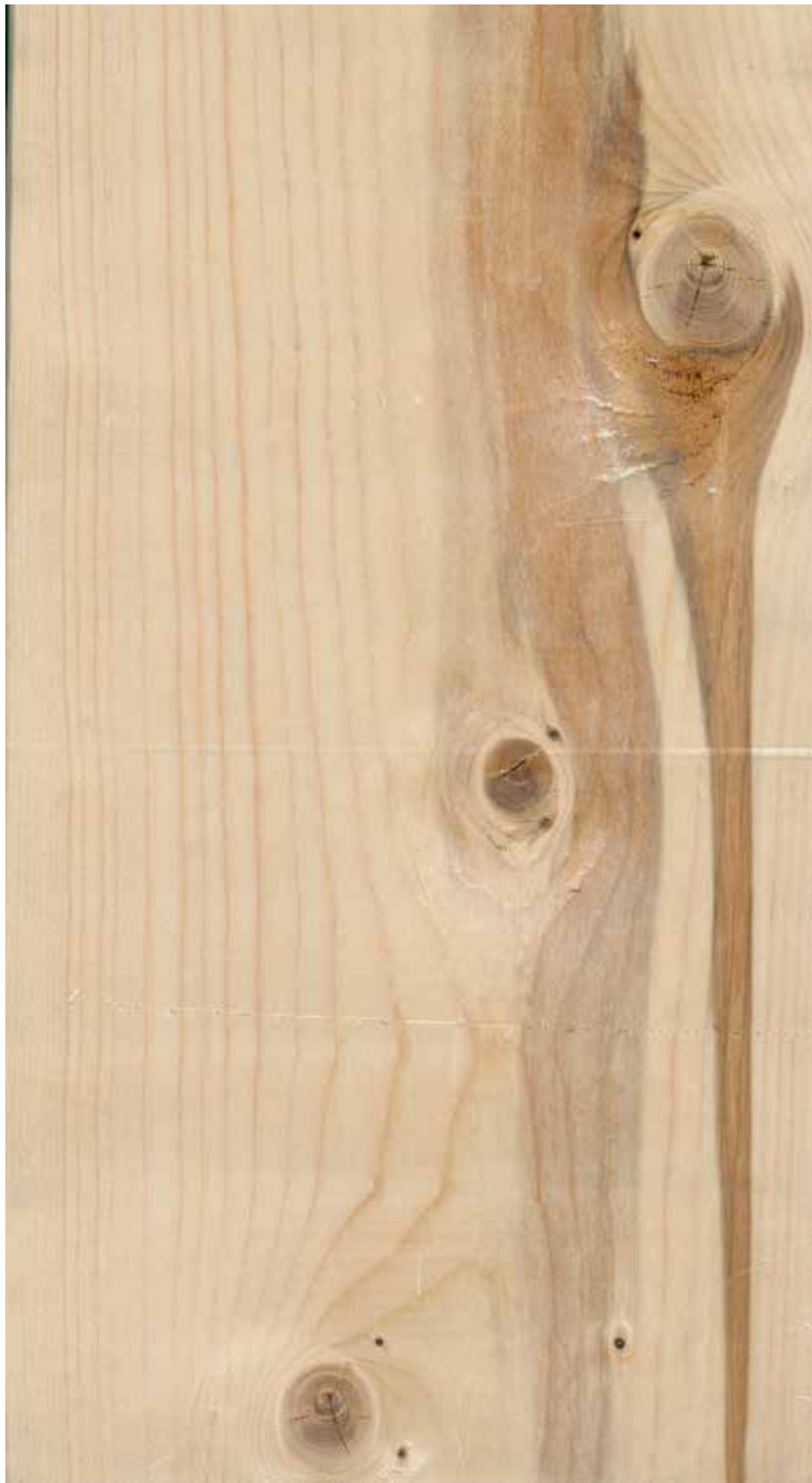
Figur 22. Råte, planken vrakes.
