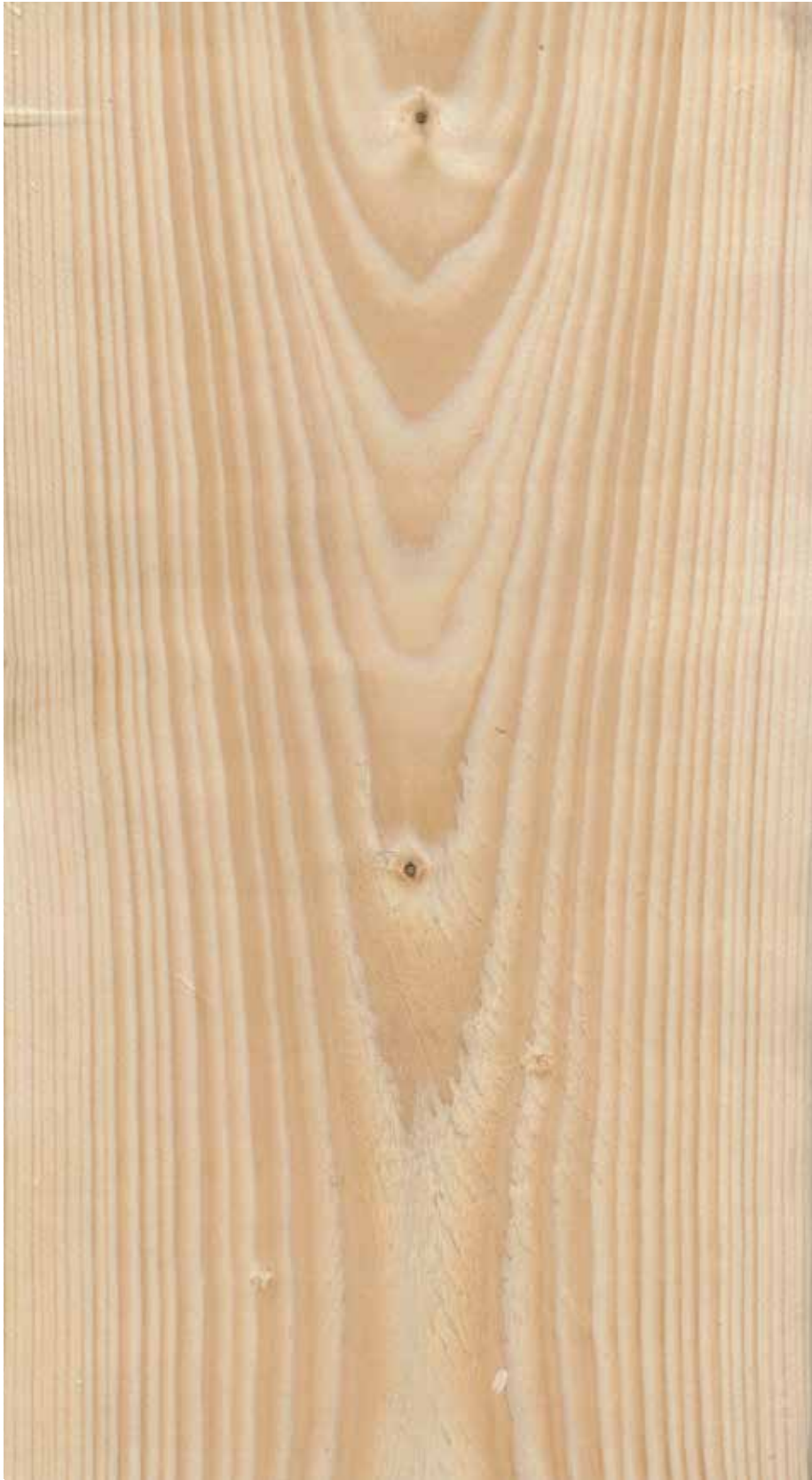
Figur 32. Den mørke delen av årringen er breddt ut over overflaten og det er en tendens til noe tennar. Ingen nedklassing av denne planken.
