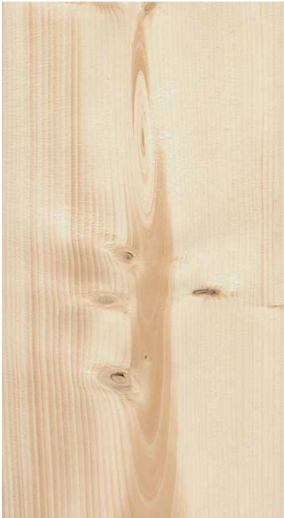
Figur 36. Tennar rundt et lite vre. Ingen nedklassing av denne planken.
