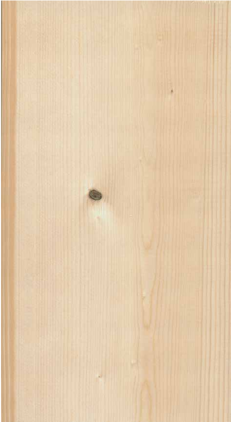
Figur 40. Kraftig tennar i kanten av planken. Det er grunn til å tro at planken vil få kantkrok, planken vrakes.
