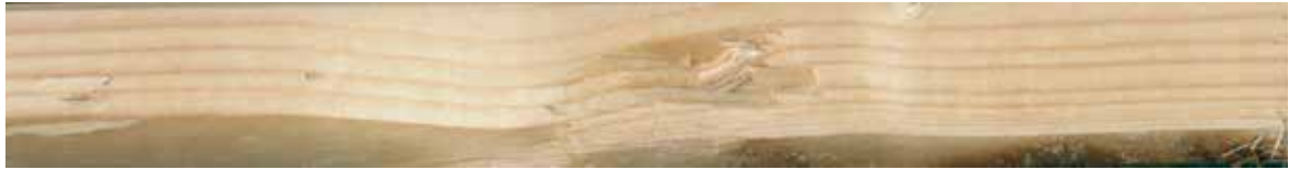
Figur 74. Skade på kant. Planken vrakes.
