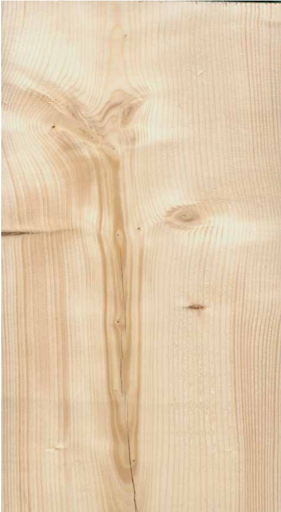
Figur 34. Svak tennar på sidene og et område med noe mer tennar inn mot margin. Ingen nedklassing av denne planken.
