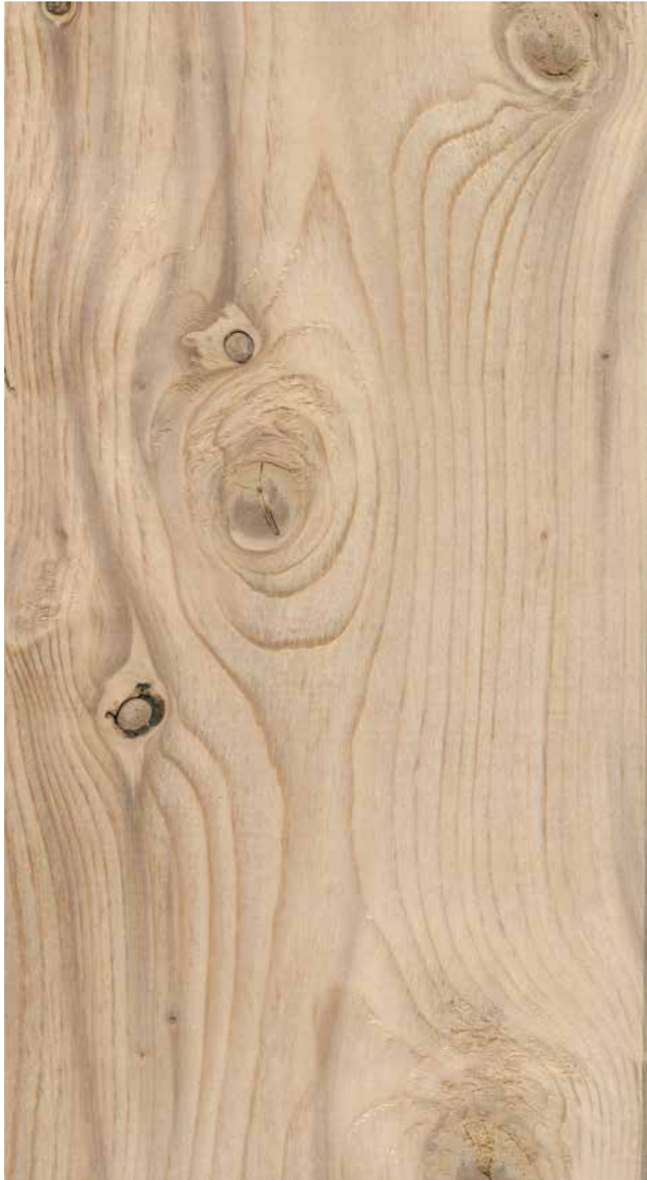
Figur 12. Bildet viser utsiden av planken, og her er det mye brent. Ofte kan man gjenkjenne brent ved at det er hvite felter rundt kvister. Planken vrakes.
