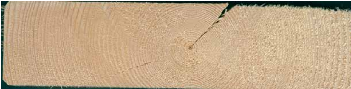
Figur 81. Dersom en tørkesprekk er grunnere enn halve plankens tykkelse, godtas den uten begrensninger i alle styrkeklasser. Dersom mærgen ligger i midten eller tilnærmet i midten av planken, kan man ikke være sikker på at sprekker som synes på begge flatsider, virkelig møtes på midten, derfor godtas også en slik planke uten begrensninger i alle styrkeklasser.
