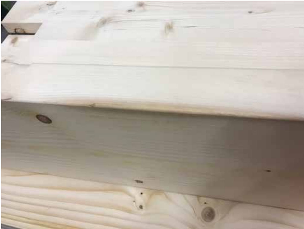
Figur 3. Er denne brune fargen på kanten brent eller barkbrunt? Det er ikke godt å si... det kan tolkes som barkbrunt, og derfor er nedklassing ikke nødvendig.
