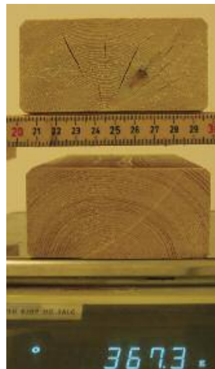
Avslutning. Ved 367.3 g på den impregnerte biten ble tørkingen avsluttet, og man kan se at den andre biten har begynt å lukke sprekkeene igjen.
