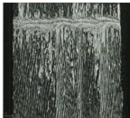
Computertomografi av limfugen ved konvensjonell liming (til venstre) og grønnliming (til høyre) av trevirke.
