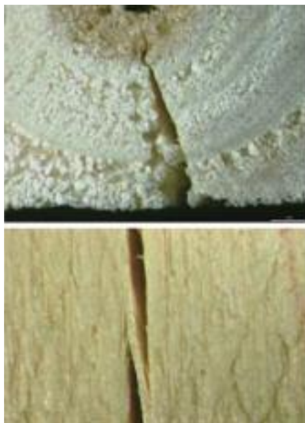
Tørkesprekker i trevirke for varmebehandling observert ved 10x forstørrelse. Kilde: Altgen (2012)
