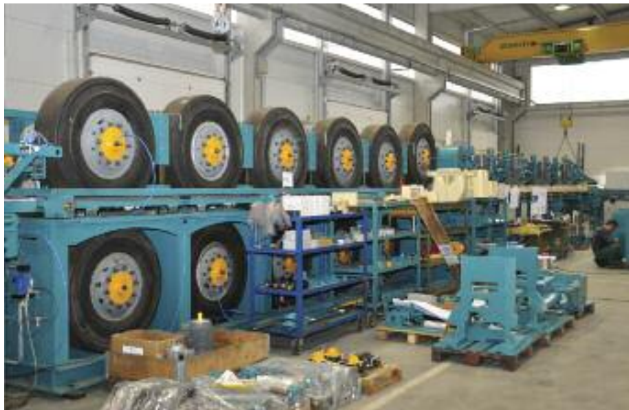
I massivtrefabrikken Mayr-Melnhof Holz i Kalwang ble det produsert fingerskjøtte lameller på opptil 36 meter. Her er pressmating i et tilsvarende fingerskjøttingsanlegg.
