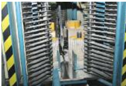
En flerbladsag med horisontale sagblader delte opp virket når det var tilstrekkelig saget ned.
