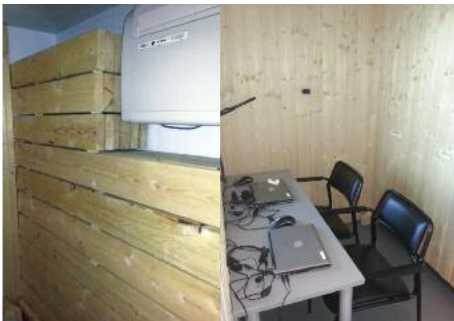
Figur 2. Bildene over viser kammerets innside, hvor vi på venstre bilde ser furuplankene stablet mot bakveggen og på høyre bilde ser den falske bakveggen som skulde furuplankene. Kammerets størrelse var ca. 7,2 \text{ m}^3 . Arealet av furuplankenes overflater som var eksponert var ca. 39 \text{ m}^2 . Dette utgjorde et eksponeringsareal i forhold til volum av kammeret på ca. 5,4 \text{ m}^2/\text{m}^3 .
