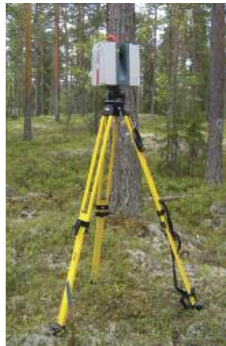
Figur 1. Laserscanner oppmontert for innsamling av data i et furubestand.
