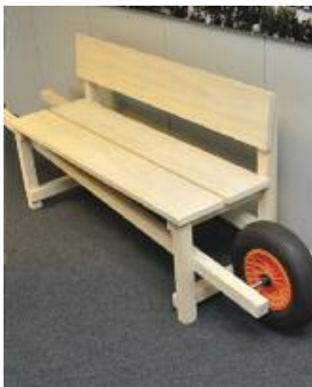
Kvistfri radiata pine impregnert med eddiksyreanhydrid.
