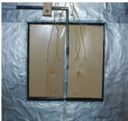
Figur 1. Treprøvene, hengt i taket for å unngå forstyrrelser av oppdrift. Ledningene inn til prøvene er fra termoelement som er kontroll av overflatetemperatur målt av termografikamera.
