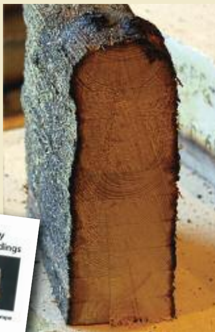
Tre brenner bare på overflaten, og beholder derfor sin indre styrke. Foto Stian Engebretsen.
