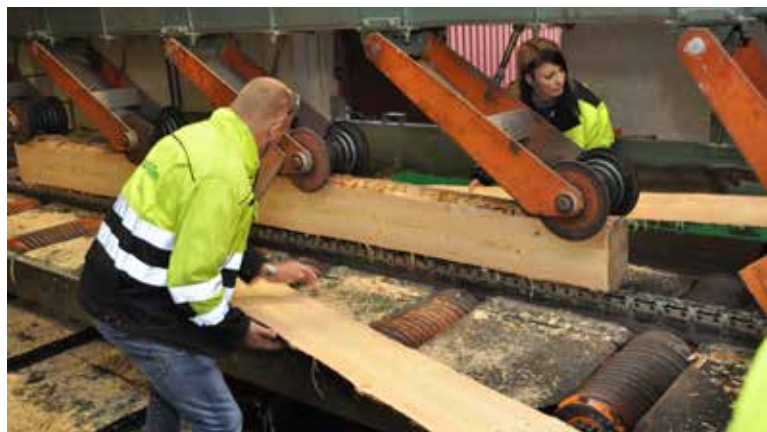
Forut for samlingen ble det foretatt målinger av sideborduttaket, for å se om saglinja var riktig innstilt. Monica Vestli og Sten Jarle Solheim fra vertsbedriften stilte velvillig opp. Resultatene ble presentert under omvisningen på bedriften.
