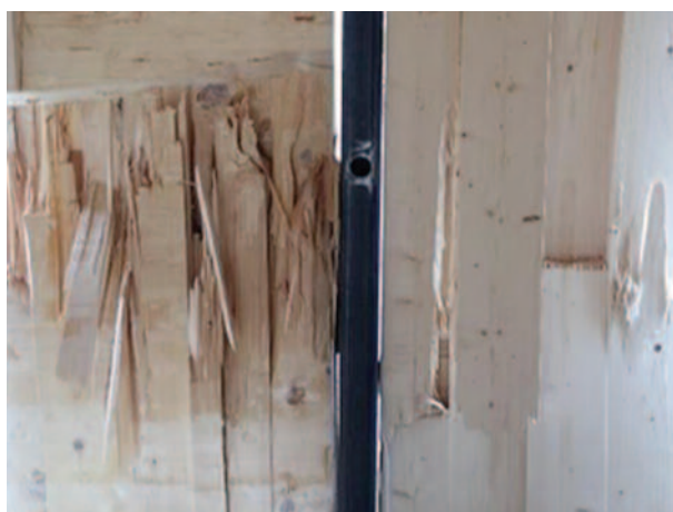
Forsøk med eksplosjonslast med 12 meters avstand.
