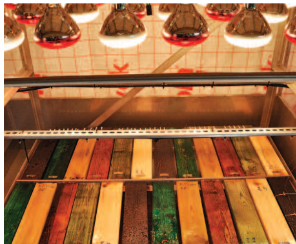
Testing sprekkdannelse - akselerert væralding.
