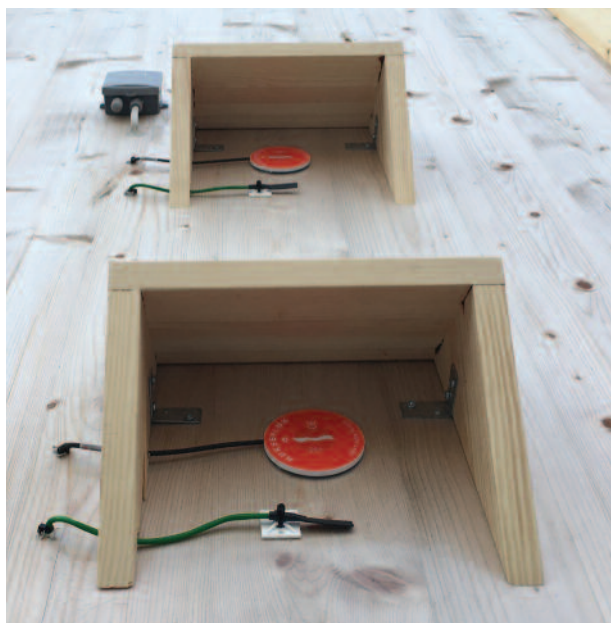
Forsøk med eksplosjonslast med 12 meters avstand.
