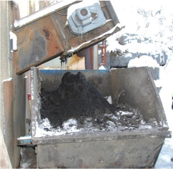
Figur 4: Mellomlagring av aske på sagbruk i et eldre forbrenningsanlegg hvor det ikke skilles mellom flyve- og bunnaske.
