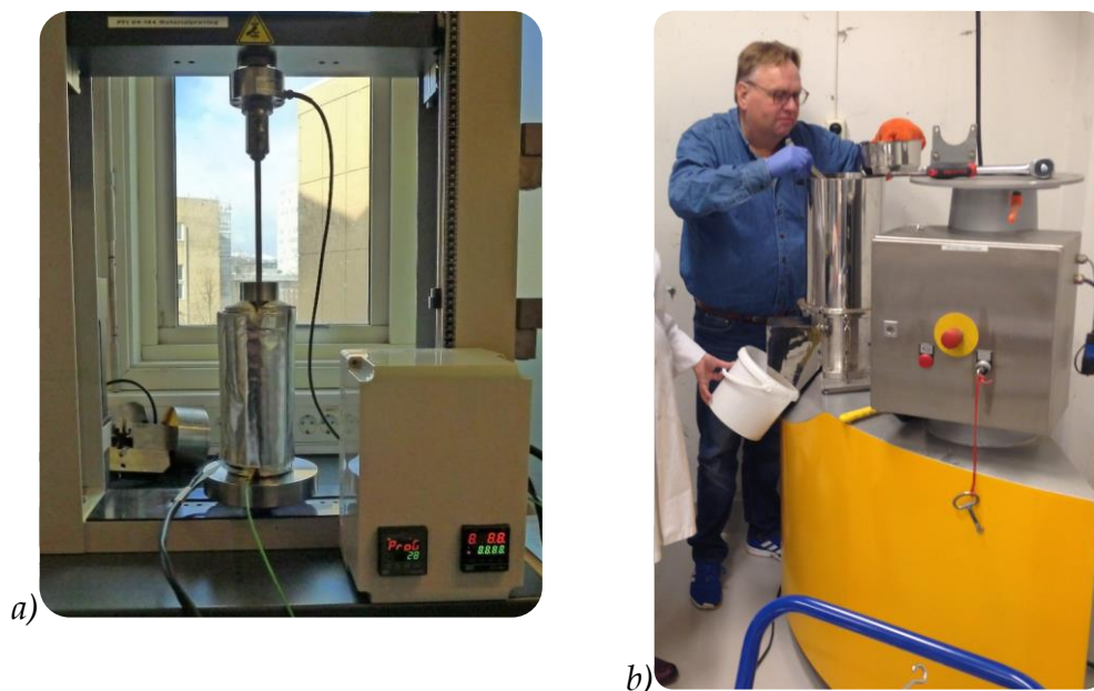
Figur 5.1. Utstyr for pelletering av aske ved PFI. a) Enkel pelleteringspresse med regulerbar temperatur, trykk og hastighet under pelletering b) Operatør senioringeniør Trond Karlsen ved Kahl valse-pelleteringspresse.
