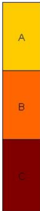
Figur 5. Hver prøve (kledningsbord) er delt inn i 3 soner, A, B og C, som er evaluert separat.
