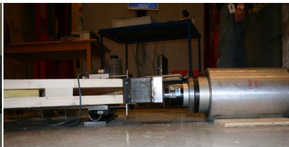
Figur 12. Ved lastinnføring er det laget til et rullelager på undersiden av elementet.
