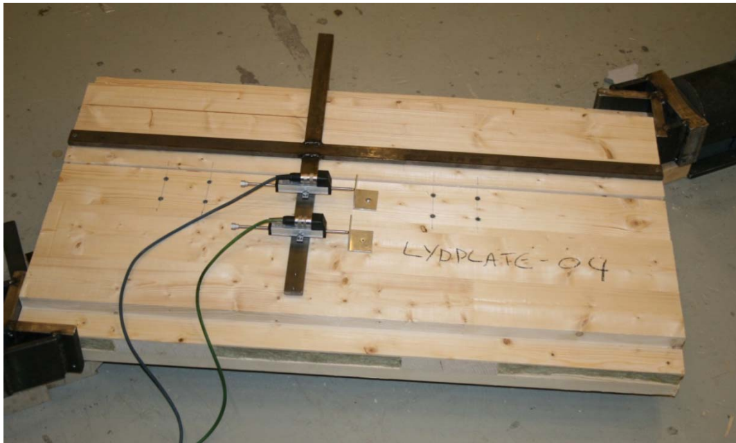
Figur 15. Testoppsett ved skjærtesting av testserie 3b (seks av prøvene ble testet med heltre skjøtebord og to av prøvene ble testet med skjøtebord av kryssfiner). Det er montert på et stålkryss hvor deformasjonsmålere er plassert hhv. midt over skjøtebord og litt ut på siden av skjøtebord, slik at vinkelendringer kan måles. På bildet er det kun to tverrbord i elementet for innfesting av treskruene. Det er benyttet to skruer pr. tverrbord på hver side av skjøten.
