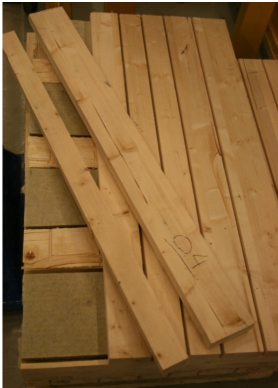
Figur 20. Prøve nr. 4: Lameller på overside løsnet under testing (skjærebrudd).
