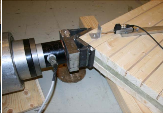
Figur 10. Lastinnføring med stålvinke med dimensjon 100x100 mm.
