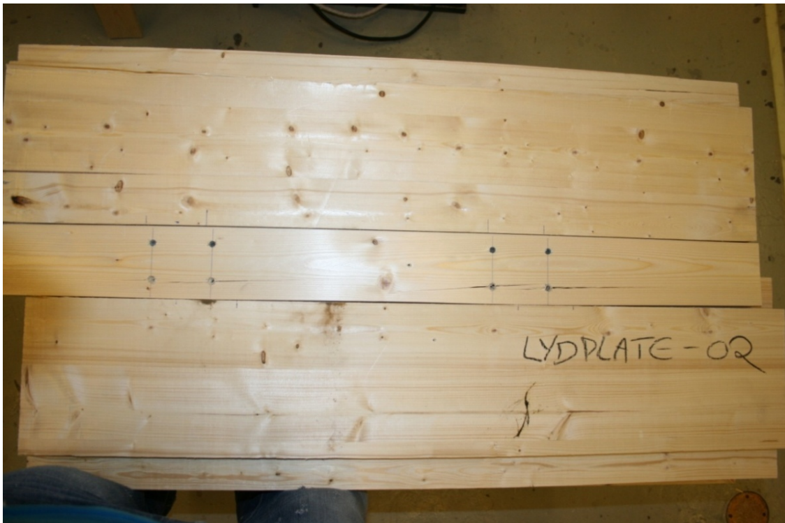
Figur 29. Prøve nr. 2: Skjærbrudd og delvis oppsprekking mellom skruer på rekke.
