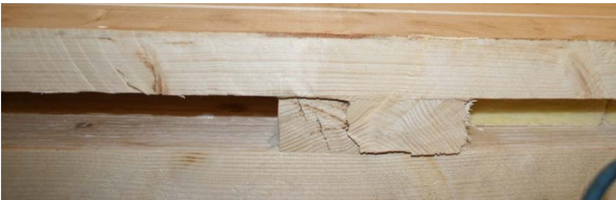
Figur 18. Prøve nr. 2: Skjærbrudd i tverrlamell.
