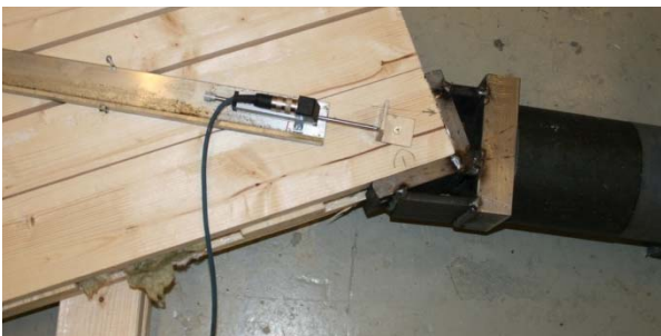
Figur 11. Mothold (fastpunkt) med stålvinke i dimensjon 100x100 mm.
