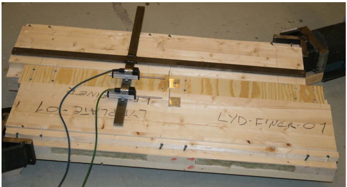
Figur 311. Prøve nr. 7: Skjærbrudd i forbindelsen mellom elementene ved bruk av kryssfinér skjøtebord. Det ble ikke observert oppsprekking mellom skruene ved bruk av kryssfinerbord skjøtebord.
