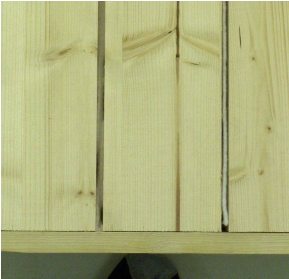
Figur 5. Sliser med filt som motstand i "halsen".
