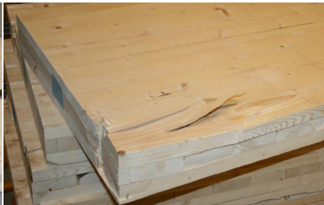
Figur 23. Prøve nr. 9: Nærbilde av lokal knusing ved lastinnføring.
