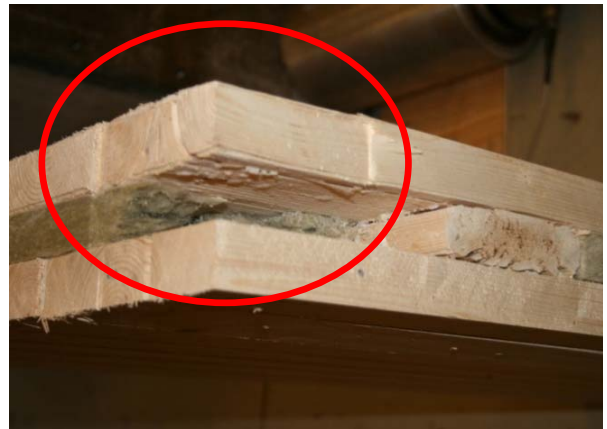
Figur 21. Ved lastinnføring ble det observert en del inntrykning av prøveelementene. I eksempelet er det ikke noe tverrsjikt ved lastinnføring, slik at yttersjiktene må ta opp all lastinnføring.
