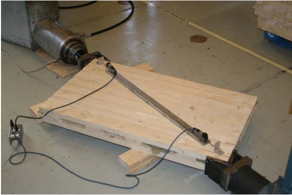
Figur 9. Oppsett for skjærtesting av massiotre elementer på gulv. Med deformasjonsgivere for testserie 1.
