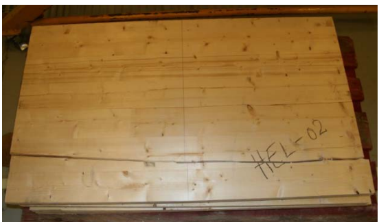
Figur 24. Prøve nr. 2: Lastinnføring medfører lokalt stor belastning på en eller noen få lameller som medfører lokalt skjærbrudd.
