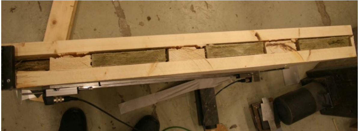
Figur 19. Prøve nr. 2: Skjærbrudd (rulleskjær) i flere toerlameller.
