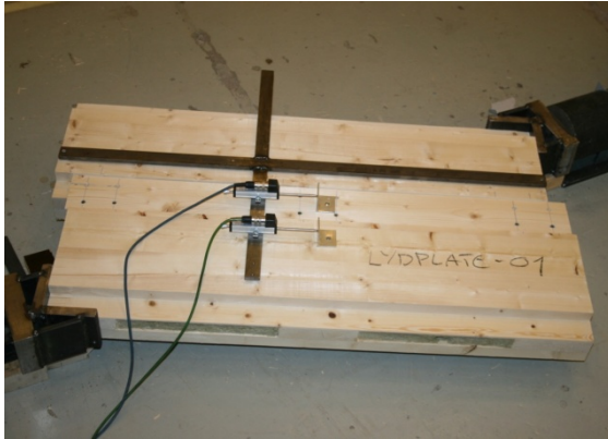
Figur 27. Prøve nr. 1: Oppsprekking mellom skruer og til kant samt skjærbrudd i forbindelsen mellom elementene.
