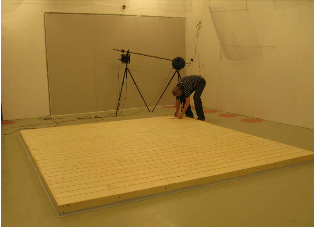
Figur 3. Klangrommet med testelementene lagt ut. Kanten rundt er forseglet for kun å måle dempningen fra elementets overside.
