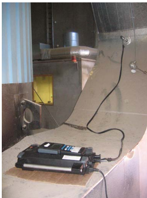
Figur 16. Røykgassmåling på forbrenningsanlegget.
