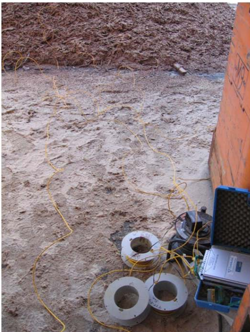
Figur 4. Instrumentering av barkhaug ved KSH.
