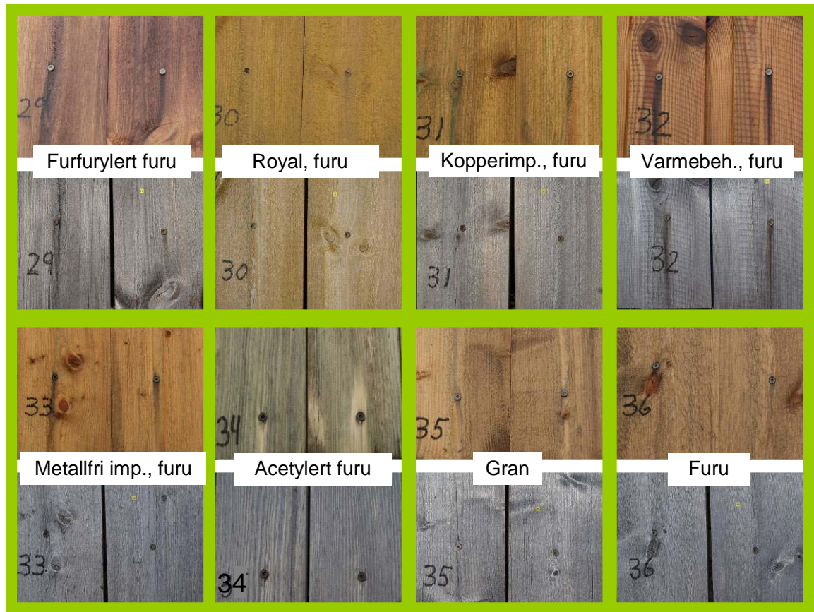
Figur 24. Første og tredje rad viser tresubstratene etter fire måneders eksponering. Andre og fjerde rad viser fargeendringen etter tre års eksponering.
