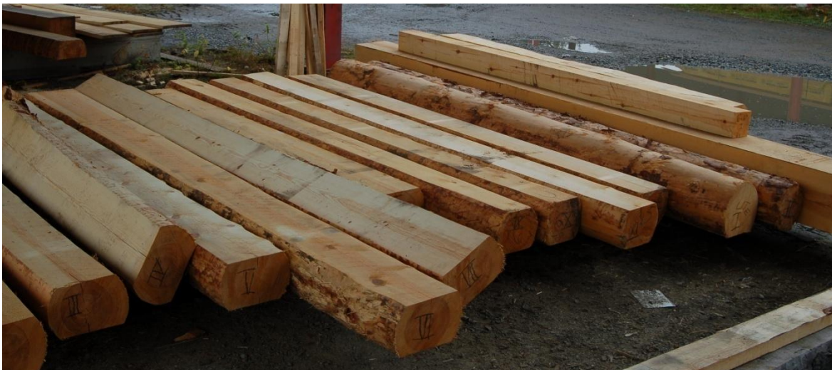
Bilde 2: Store dimensjoner klare for måling av sprekker og fuktighet.
