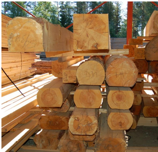
Bilde 1: Store dimensjoner stikklagt for friluftstørking ved Kistefos Sag.
