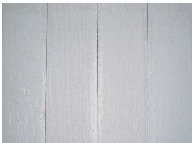
Prøve 6 – modifisert oljemaling. Eksponert i 1000 timer i QUV-kammer.
