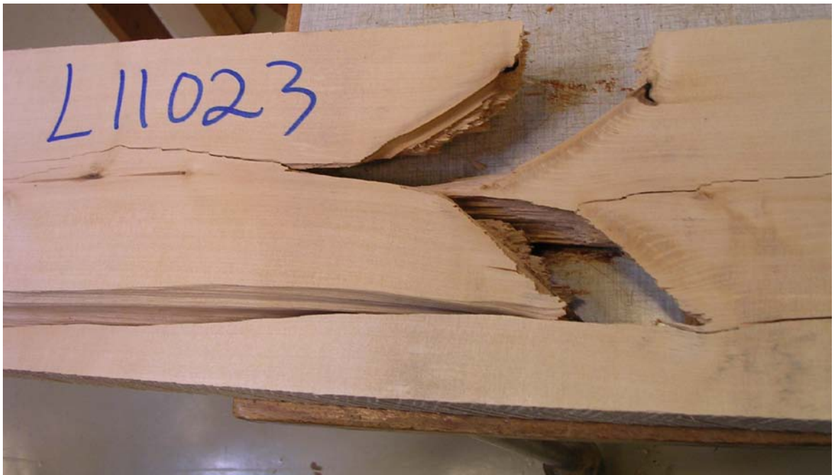
Figur 2.8. Eksempel på strekkbrudd i bladkvist.
