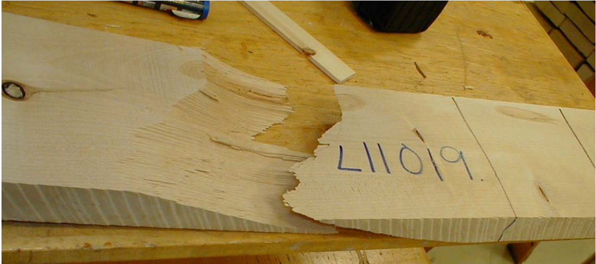
Figur 2.7. Eksempel på strekkbrudd i skråfibret virke. Fiberhellingen kommer fram over kant.
