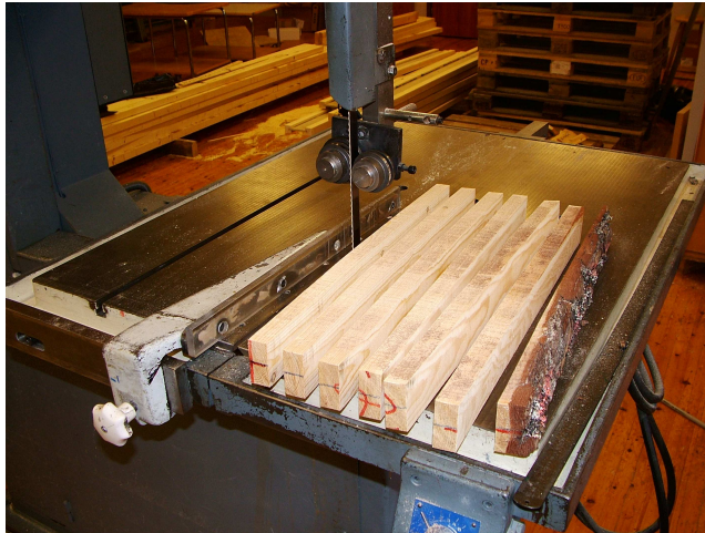
Figur 7. Fra den midtre slisse skjæres prøvestaver ut. (Wenzlow 2006).
