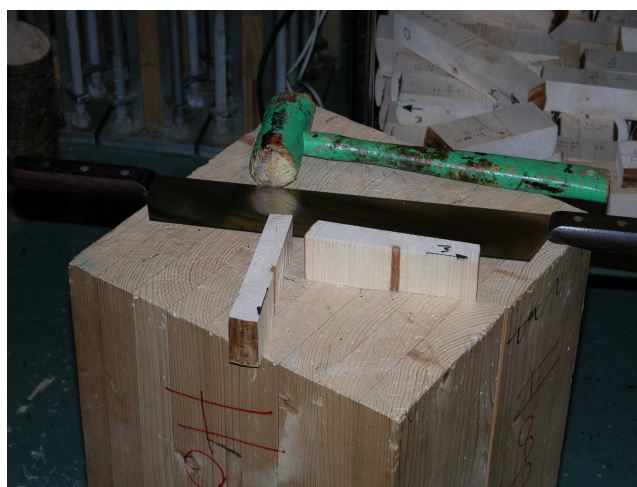
Figur 21. Prøvestykke etter spaltning, klar til måling. (Wenderdel 2006).
