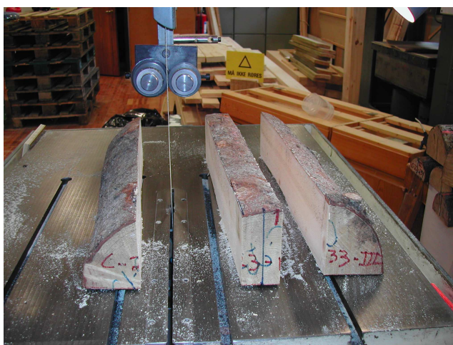
Figur 6. Midtre slisse i vestretning skjæres ut.
