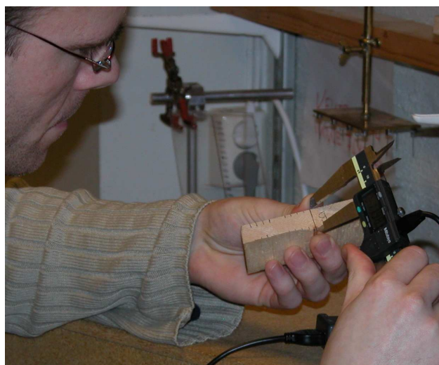
Figur 23. Registrering av margens symmetri i forhold til prøvestykket. (Wenderdel 2006).
