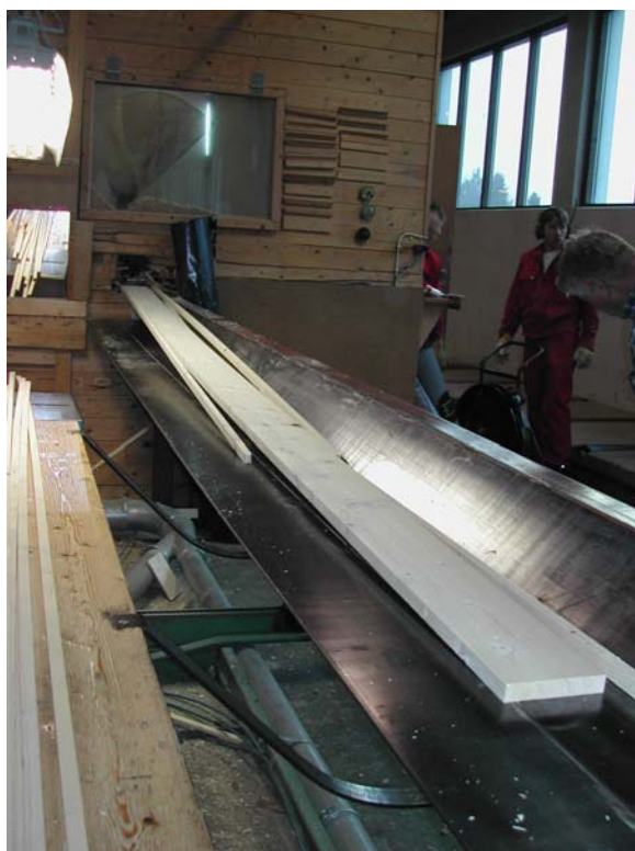
Figur 5. Produksjon av tømmermannskledning ved saging av kant (oppsett 2).
