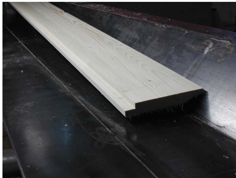
Figur 7. Ferdig produsert dobbeltfalskledning.
