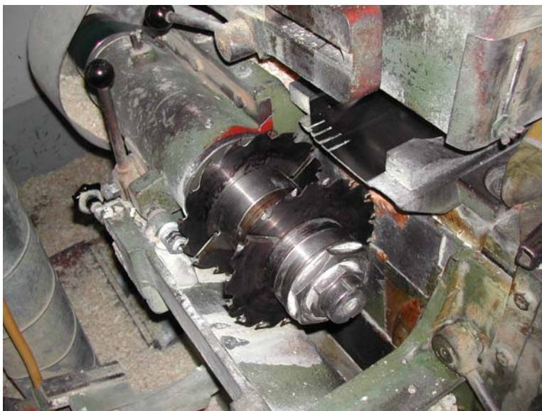
Figur 4. To sagblad på underkutter til produksjon av tømmermannskledning etter oppsett 2.
