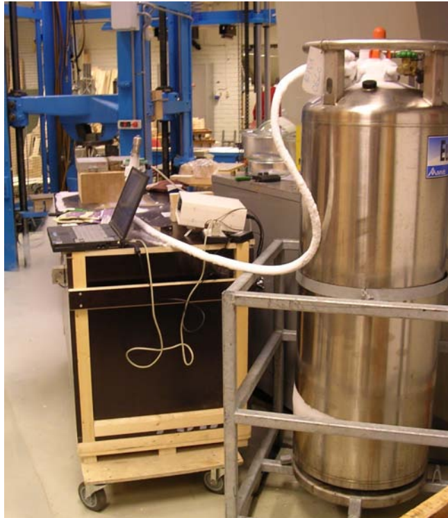
Figur 3. Kjøletank tilknyttet beholder for flytende nitrogen.
