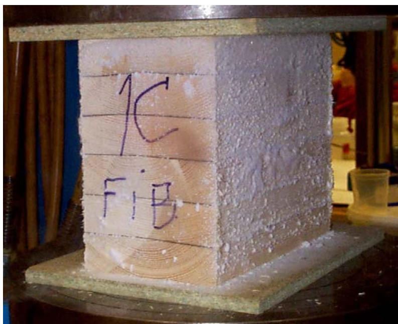
Figur 12. Luftfuktigheten kondenserte og la seg som rim på kalde prøvestykker.
