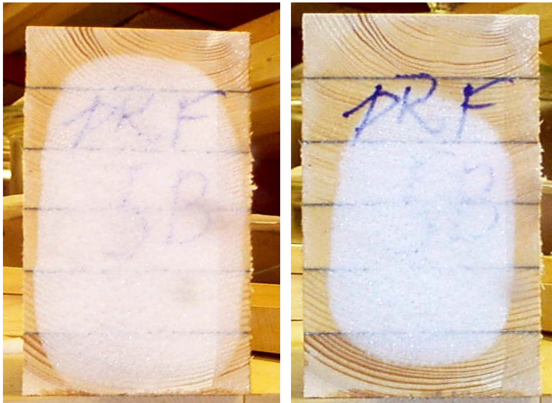
Figur 11. Et nedkjølt prøvestykke venter seg gradvis til romtemperatur.
