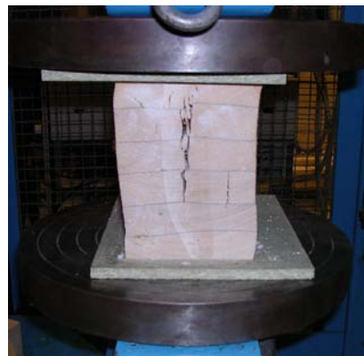
Figur 6. Eksempel på prøvestykke etter brudd.
