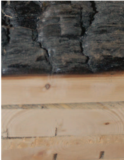
Brannforsøk utført ved brannlaboratorier kan dokumentere at et etasjeskille av massivtreelementer med tykkelse 160 mm krysslågt element med 5 sjikt med eksponert over- og underside oppfyller funksjonskravene REI 90. Massivtreelementene var forbelastet med 3 kN/m².
