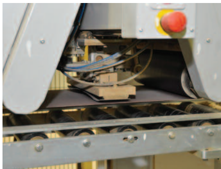
Sliping av panel.
