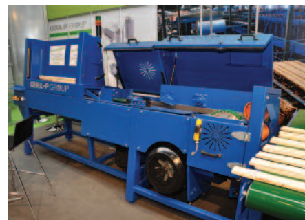
Emnene deles først ved et horisontalt sagblad, og så flere vertikale. Obel-P Group.
