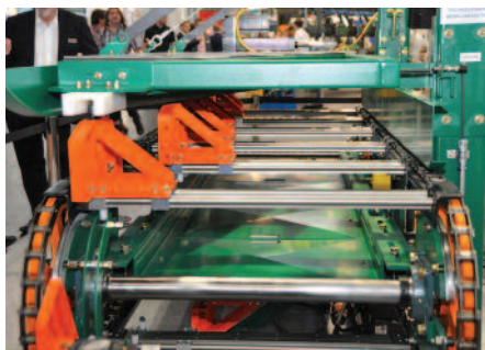
Her ligger den lette planken stille og endeslaget beveger med seg opptil 250 medbringere pr min. USNR.
