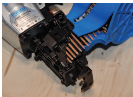
Spikerpistol for spikring med form-preset bokespiker 3,7 mm i diameter og lengde 50 – 65 mm. Trenger ikke forboring, og ligninet fester pluggen/spikeren.
