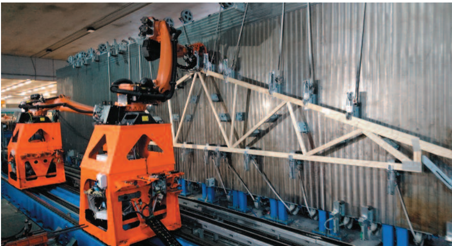
CAD/CAM drevet takstollinje med automatisk kapping. Vertikal produksjon av takstoler med robot for plassering og påføring av spikerplater og pressrulle. Trussmatic.
