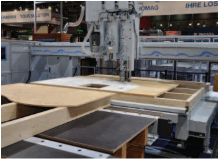
Elementlinje for vegger, tak og arker. Standard bredde 3,2 meter og valgfri lengde. CAD og CNC informasjonsstyrt sag, fres og festing. Weinmann.
