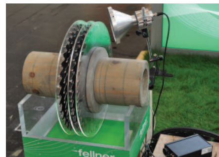
Lyddoppfølging av sagblad. Når sagblad får en høyere frekvens enn det er kalibrert for, så senkes matehastigheten i løpet av et sekund. Fellner.
