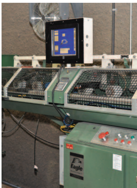
Optimalisering og automatkapping. Avkapp uten verdi blåses vekk etter kapping.
