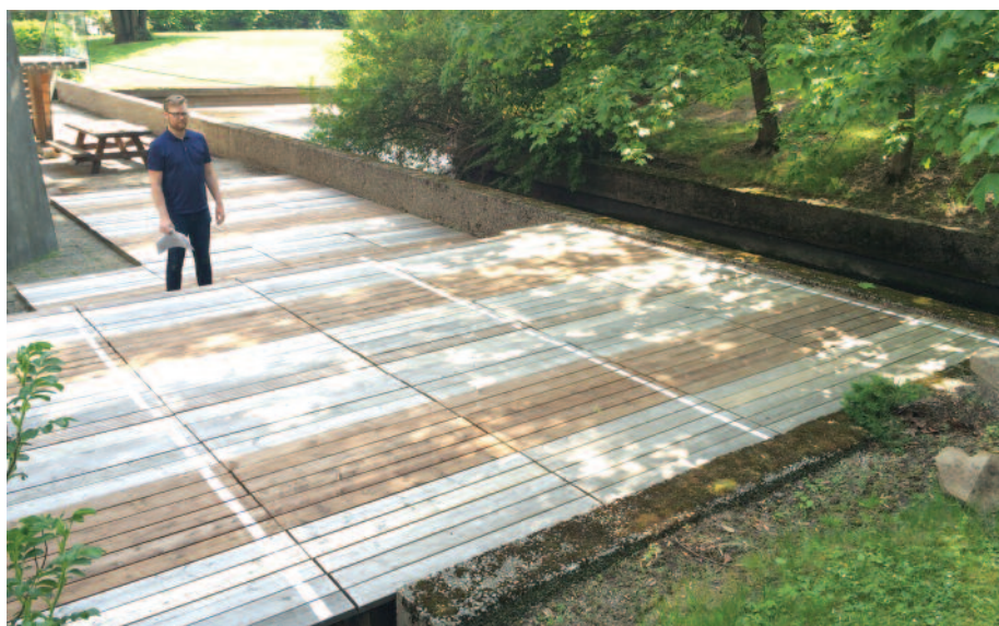
Bilde 1. Utendørstesting hos Treteknisk. Det ble bygd en lav terrasse med dårlig ventilering og en høy terrasse med god ventilering. Hver terrasse består av 10 terrasseelementer, hvorav hvert element består av 17 ulike materialer (Tabell 2).
