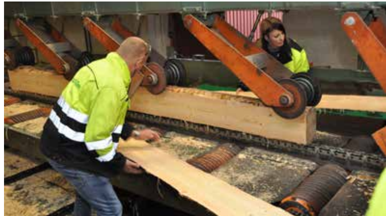
Forut for samlingen ble det foretatt målinger av sideborduttaket, for å se om saglinja var riktig innstilt. Monica Vestli og Sten Jarle Solheim fra vertsbedriften stilte velvillig opp. Resultatene ble presentert under omvisningen på bedriften.
