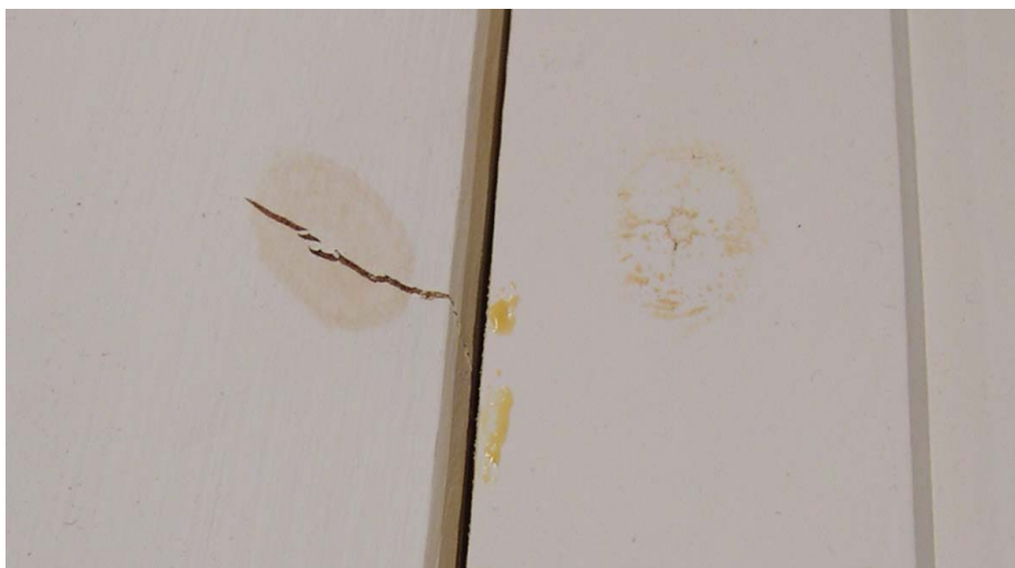
Figur 16. Utseende av kvist etter testing i QUV-kammer ved 45 °C.
